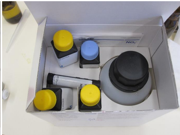
Obrázek 38 Balení metody pro měření dusičnanů od firmy MERCK obsahující činidla a AutoSelector
