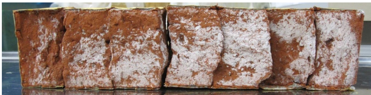
Obrázek 40 Průřez vzorku s chloridem sodným (B1)
