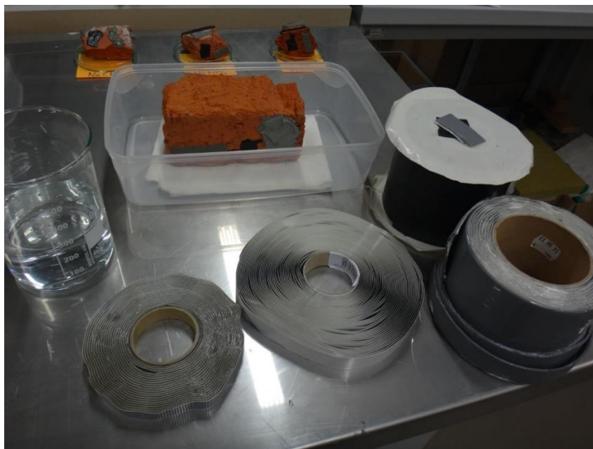
Obrázek 14 Vzorek a použité těsnící pásky
