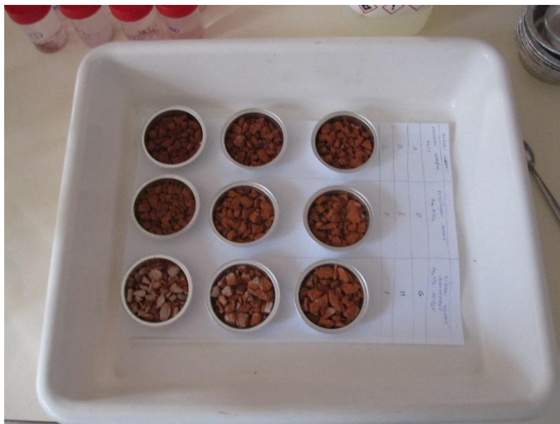
Obrázek 34 Vzorky určené pro stanovení obsahu soli
