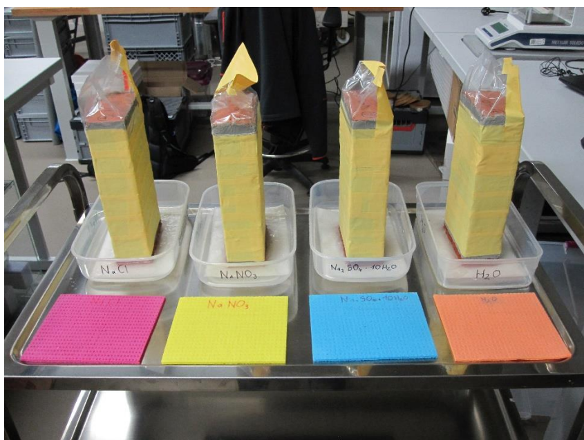
Obrázek 24 Vzorky ponořené v různých roztocích
