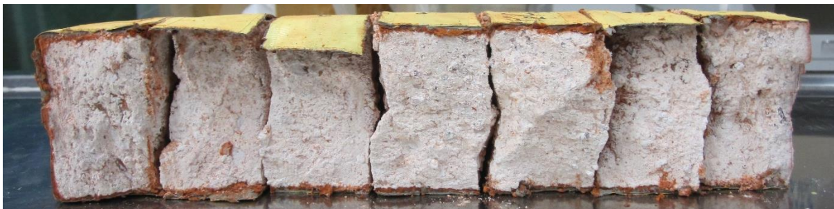
Obrázek 42 Průřez vzorku se síranem sodným (D1)
