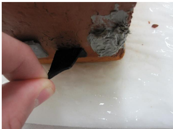
Obrázek 16 Odtrhávání lepenky ISOCELL OMEGA DB
