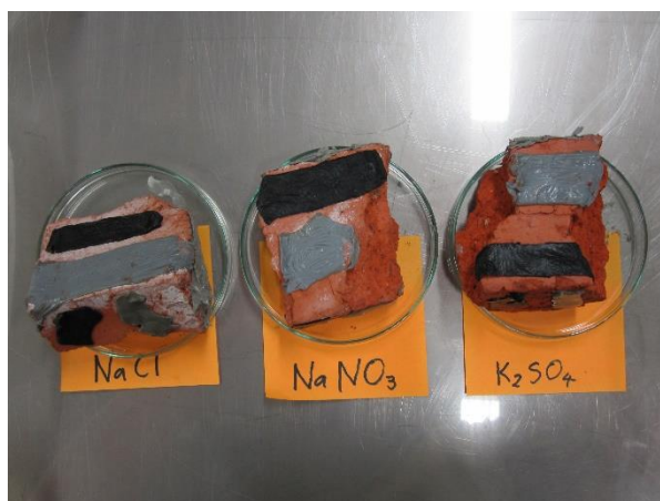
Obrázek 13 Vzorky po osmy dnech vysoušení
