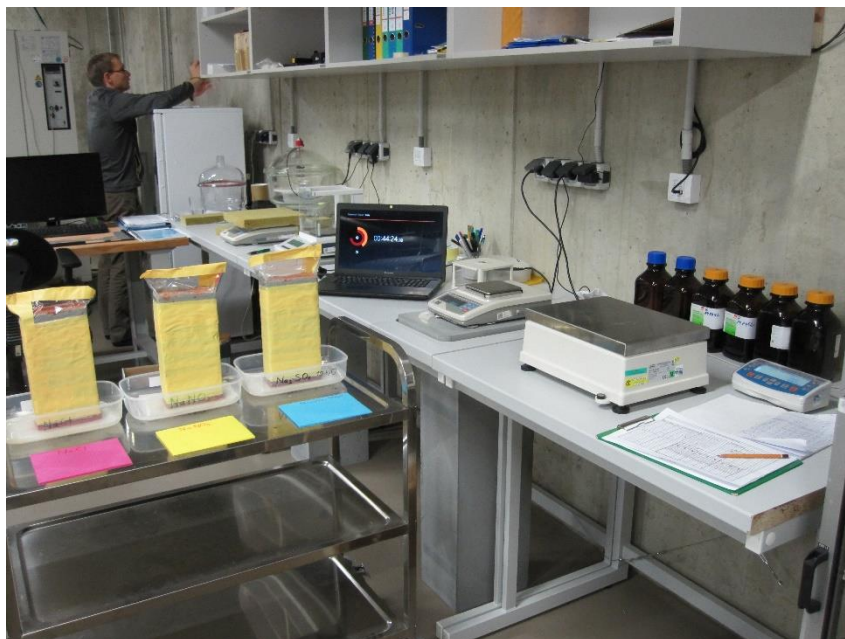
Obrázek 23 Pracovní prostor zkoušky nasákavosti
