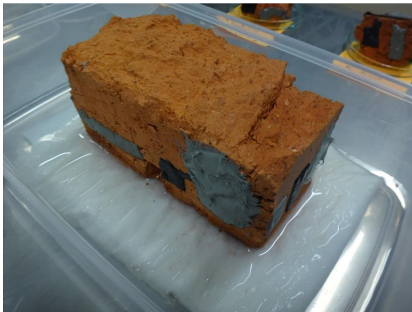
Obrázek 15 Ponořený cihelný vzorek ve vodě, který je kolem dokola oblepený vzorky těsnících materiálů
