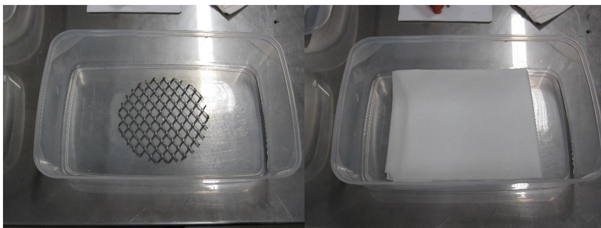
Obrázek 22 Nádoba určená pro zkoušku nasákavosti
