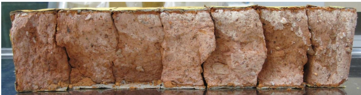
Obrázek 41 Průřez vzorku s dusičnanem sodným (C1)
