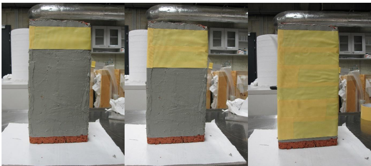
Obrázek 20 Postup pokrytí vzorku PVC páskou
