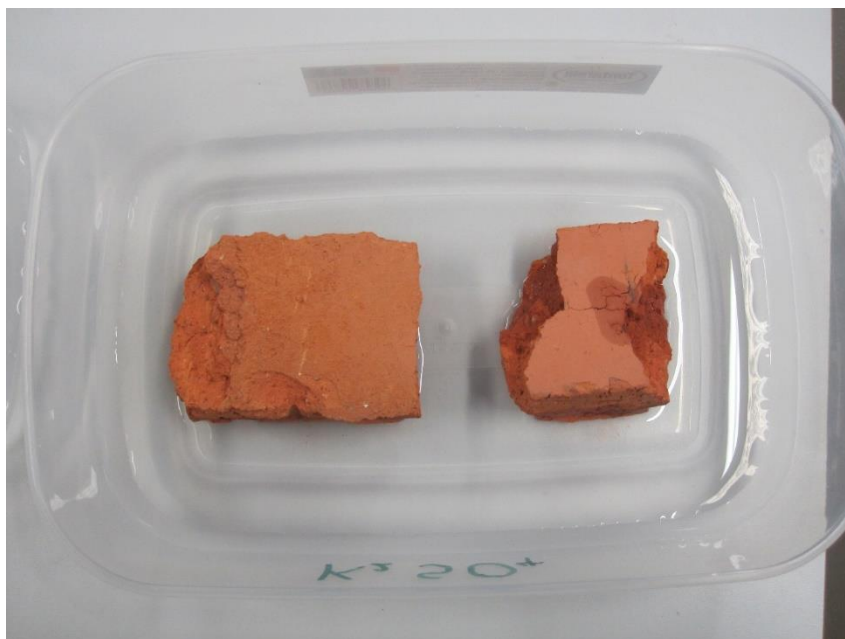
Obrázek 10 Ponoření vzorků do solného roztoku
