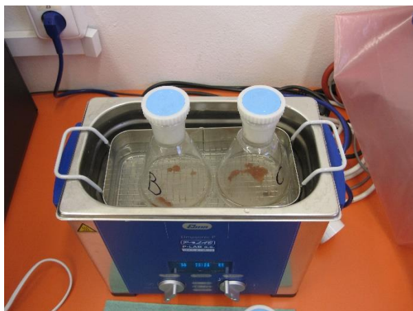
Obrázek 35 Vystavení vzorků ultrazvuku
