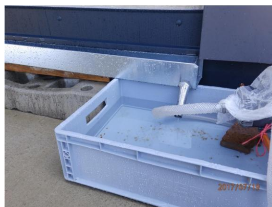
obr. 74 – Osazení vodoměru s impulzním výstupem na přívodu vody (vlevo), opatření pro zachycení odtékající vody z testovacího pole (vpravo)
