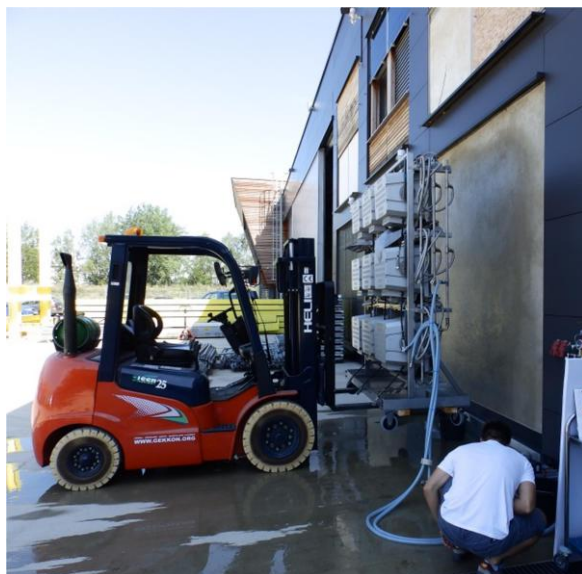
obr. 73 – Umístění kropicího zařízení a poloha trysek vůči testovacímu poli
