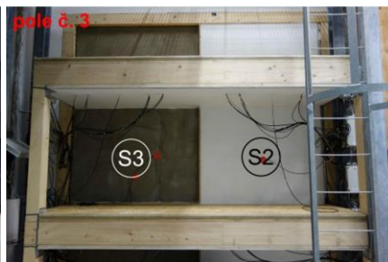
obr. 28 – Rozdělení testovacích polí s označením skladeb zateplovacích systémů, zdroj [15]
