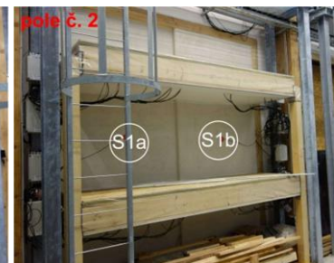
obr. 28 – Rozdělení testovacích polí s označením skladeb zateplovacích systémů, zdroj [15]
