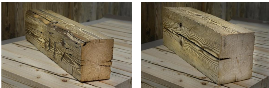
obr. 8 – Výsušné trhliny ve dřevěných hranolech, zdroj [4]
