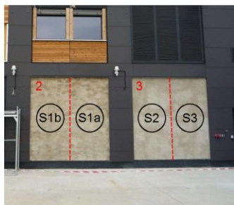
obr. 28 – Rozdělení testovacích polí s označením skladeb zateplovacích systémů, zdroj [15]
