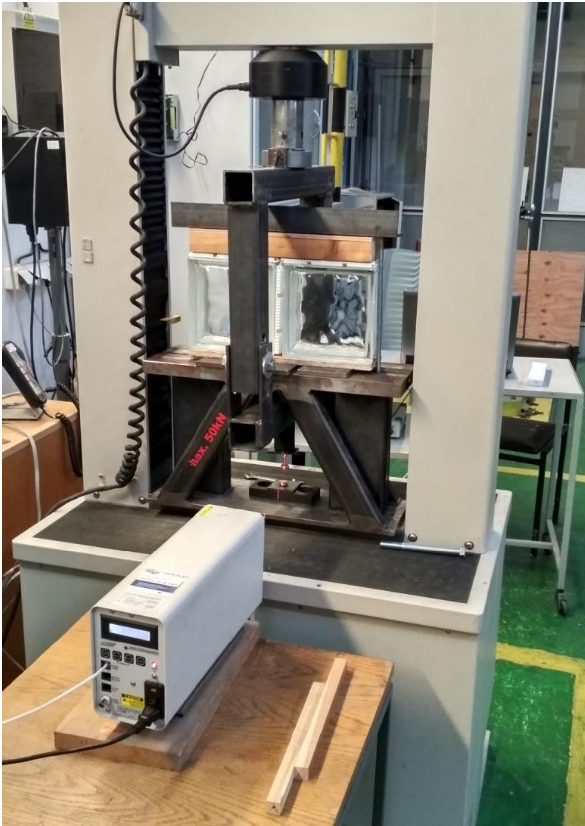
Obr. 60 Připojený laserový extenzometr
