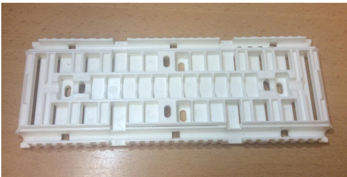
Obr. 43 Zdeformovaný vzorek po zatěžovací zkoušce
