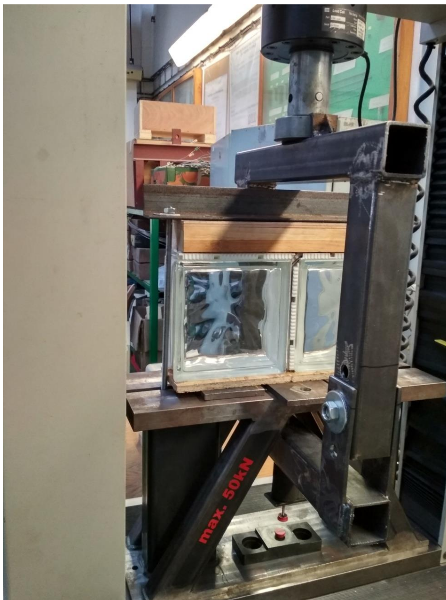
Obr. 56 Sestavený vzorek před zkouškou
