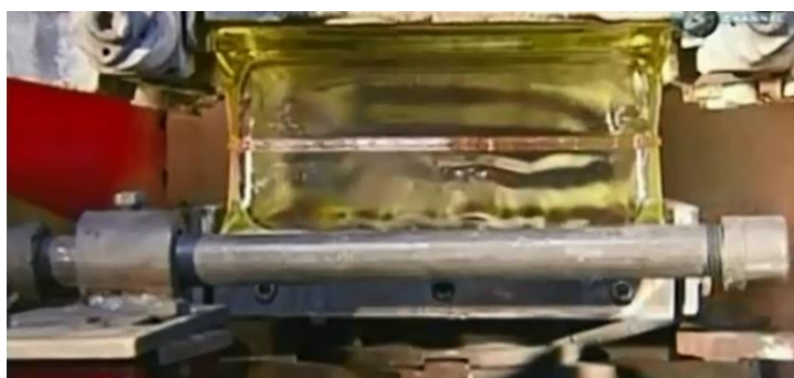
Obr. 18 Přitisknutí tvárnic roztavenými hranami [4]
