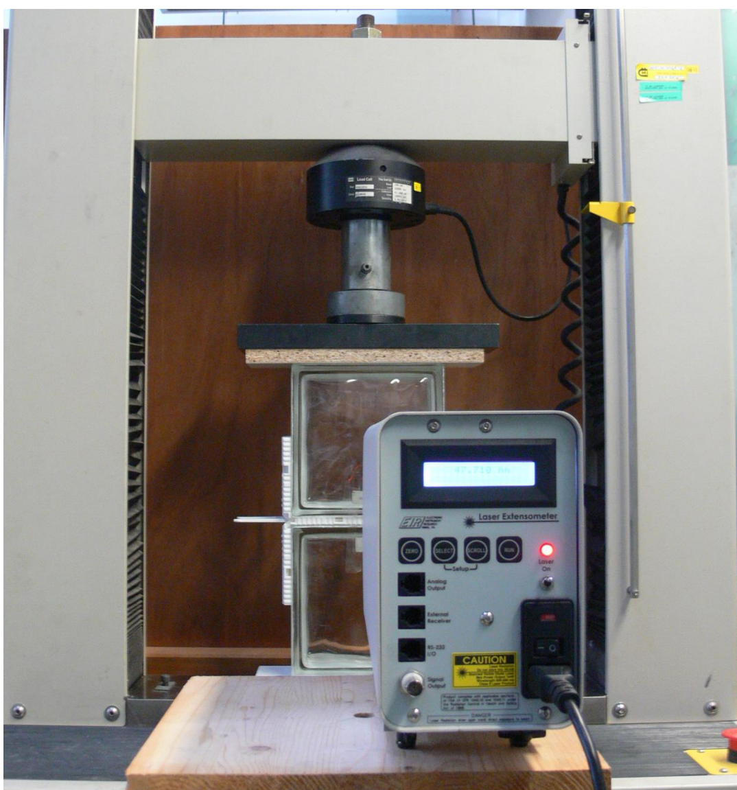
Obr. 37 Sestava s extenzometrem.
