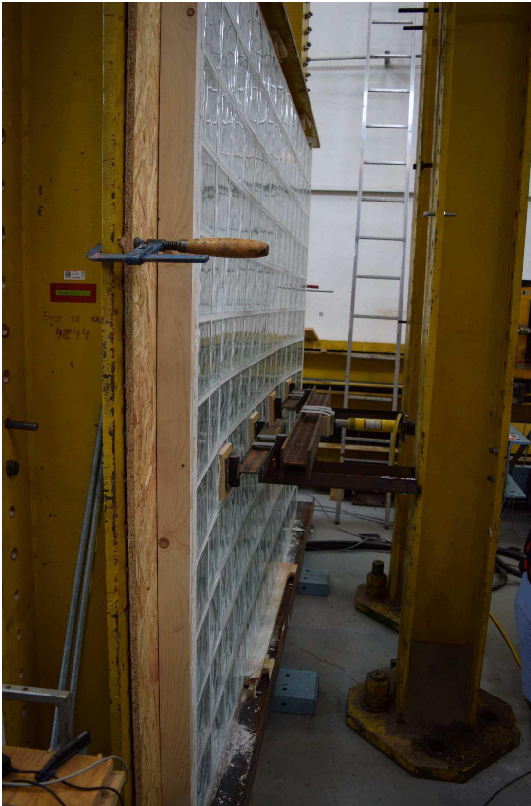
Obr. 82 Deformace stěny v závěrečné fázi zatěžování
