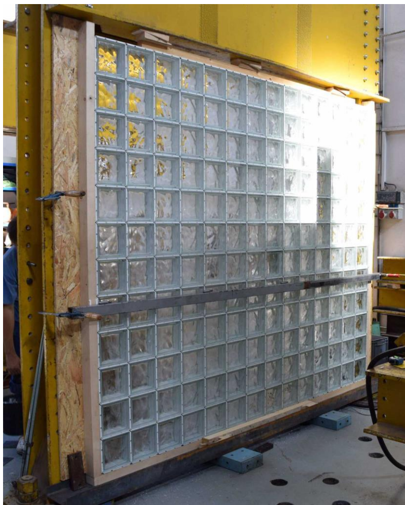
Obr. 71 Tlačená strana stěny před spárováním
