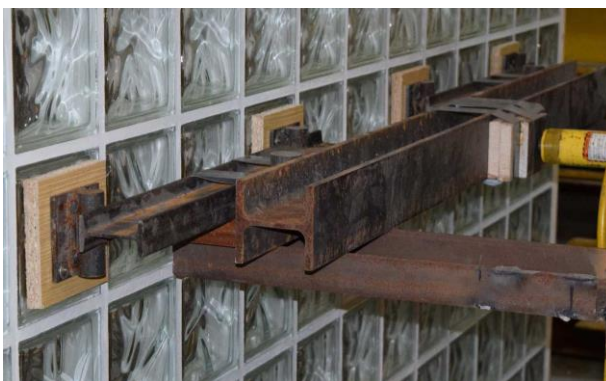
Obr. 72 Systém vahadel roznášejících zatížení
