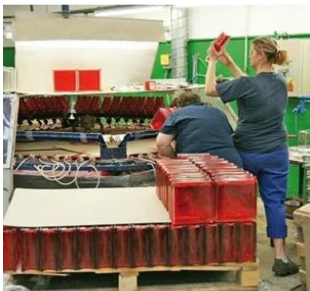
Obr. 20 Zabarvování vnitřních stěn tvárnic [4]
