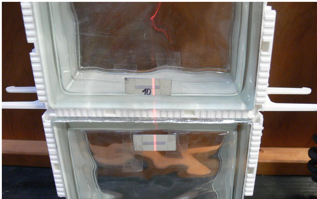
Obr. 38 Odrazové štítky přilepené na tvárnících
