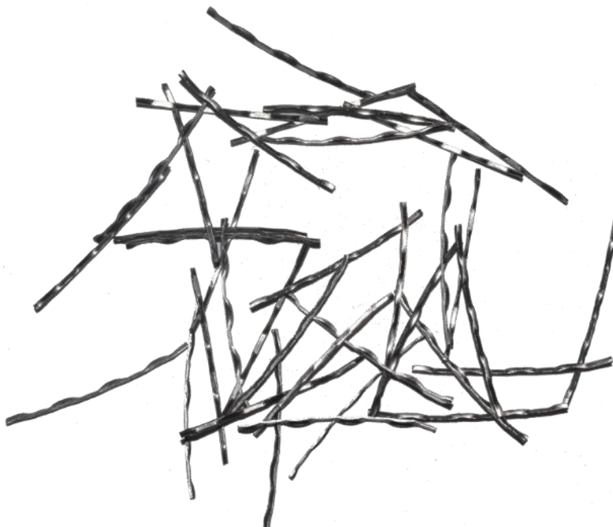
Obrázek 3: Drátek do HPC a UHPC betonu, délka 50 mm, dovozce USA [12]
