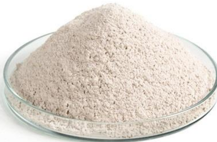
Obrázek 8: Pálený metakaolín od firmy Poraver [24]
