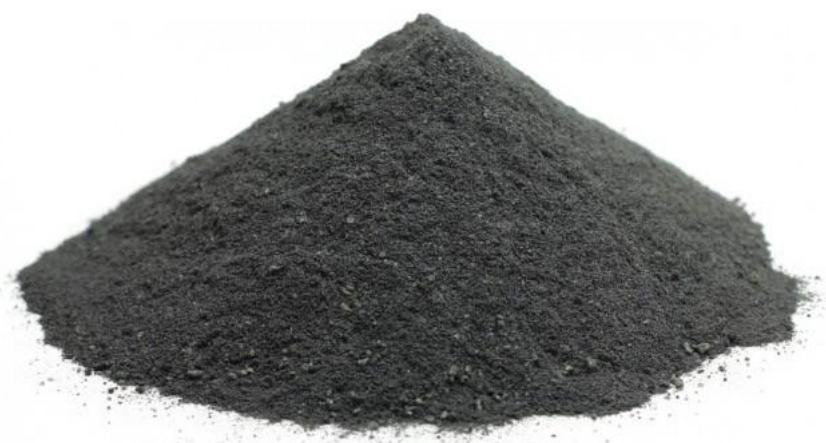
Obrázek 6: mikrosilka jako odpad výroby ferosilikátových ocelí a litiny [20]
