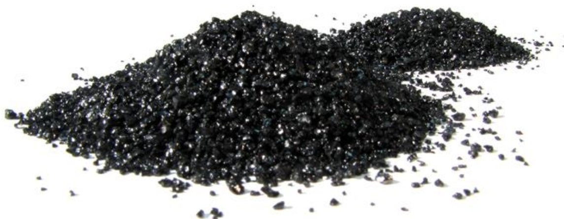
Obrázek 5: Vysokopecní struska vyrobená při tavení mědi [18]
