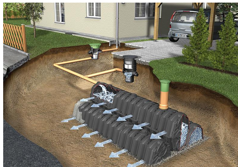
Obrázek 45 – Zasakovací tunel (Zdroj: http://www.eco-aqua-shop.cz )
