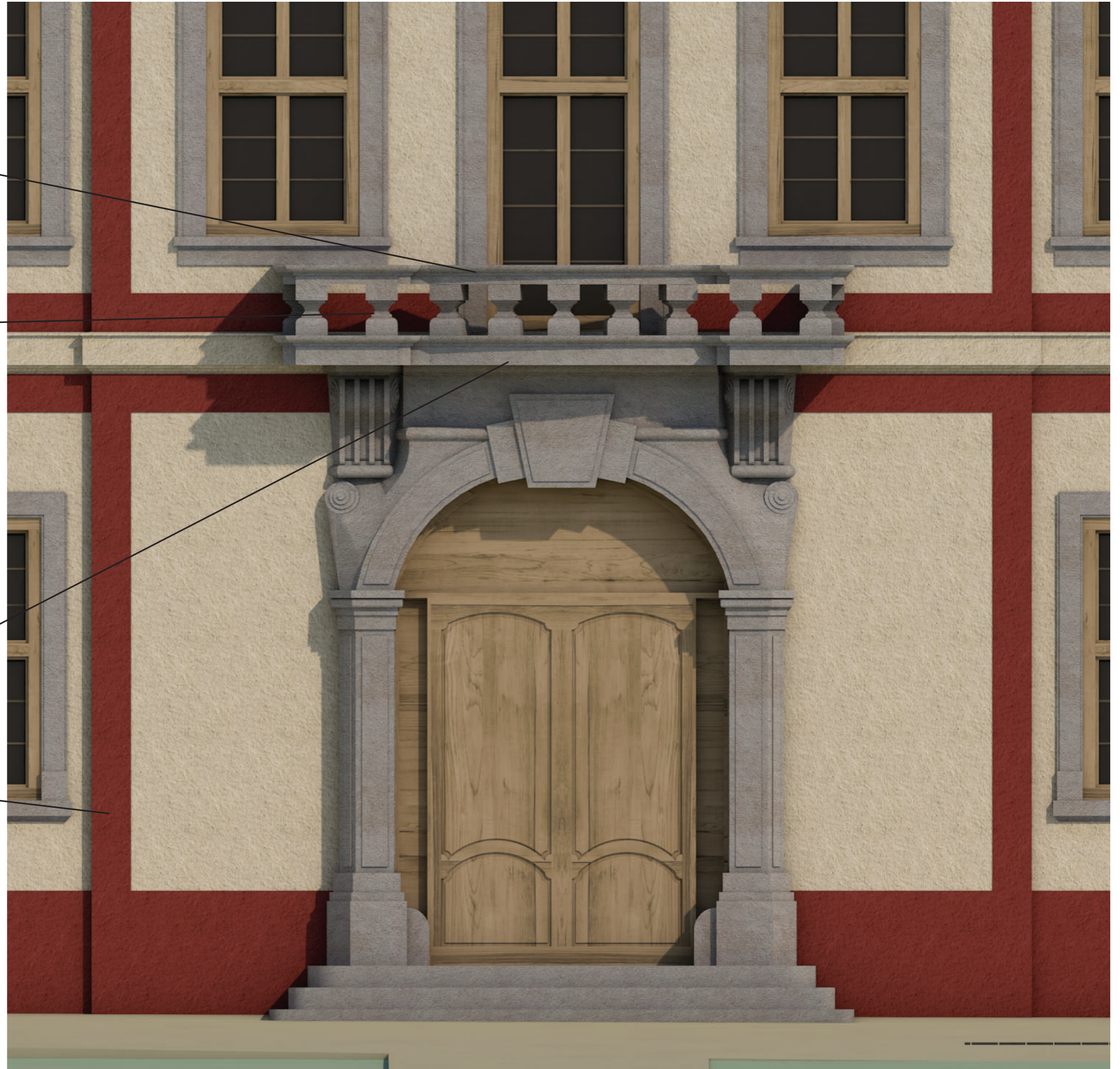
architektonický detail rekonstrukce dochovaného portálu s navazujícím kamenným balkonem, rekonstrukce původní barevnosti fasád (dle nálezových situací)
