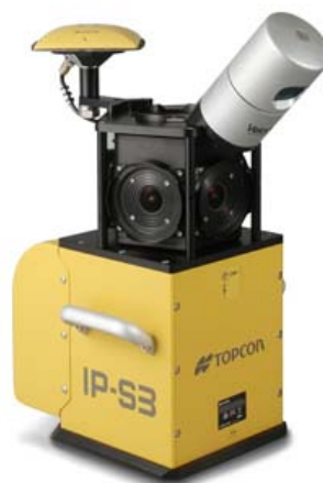
Obrázek 4.3: Mobilní mapovací systém TOPCON IP-S3 HD [16]
