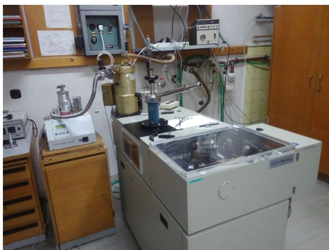
Obrázek 8.1: Fourierův spektrometr Bruker IFS 113v v laboratoři infračervené spektroskopie Fyzikálního ústavu Akademie věd České republiky, na němž bylo měření provedeno.
