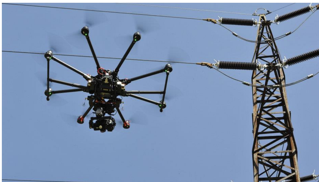
Obrázek 8. Drony pro kontrolu energetických zařízení. Převzato z [29]
