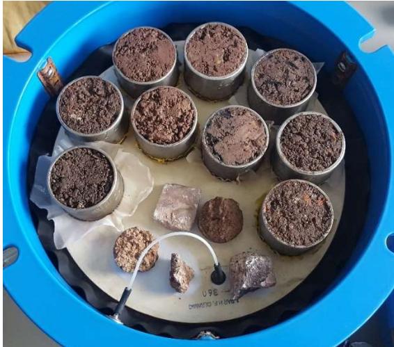
Obr. 18 Umístění vzorků zdiva v přetlakovém aparátu
