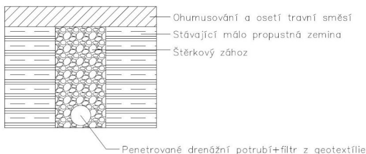
Obr. 64 Náčrtek možné podoby drenážního systému
