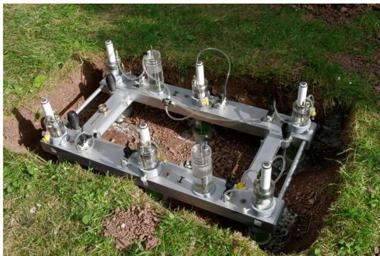
Obr. 33 Měření hydraulické vodivosti půdy
