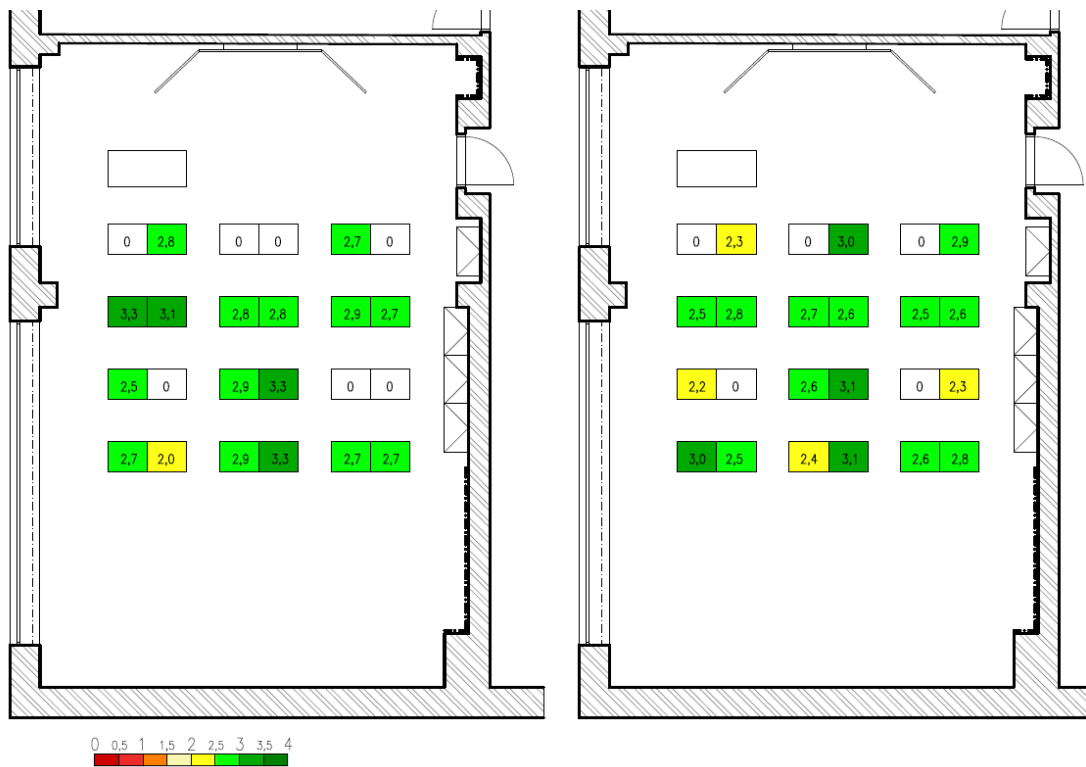
Obrázek 213: Porovnání přesvědčení žáků o pozitivním vlivu denního osvětlení pro 1. a 2. dotazníkové šetření (červená – spíše nespokojeni; zelená – spíše spokojeni)
