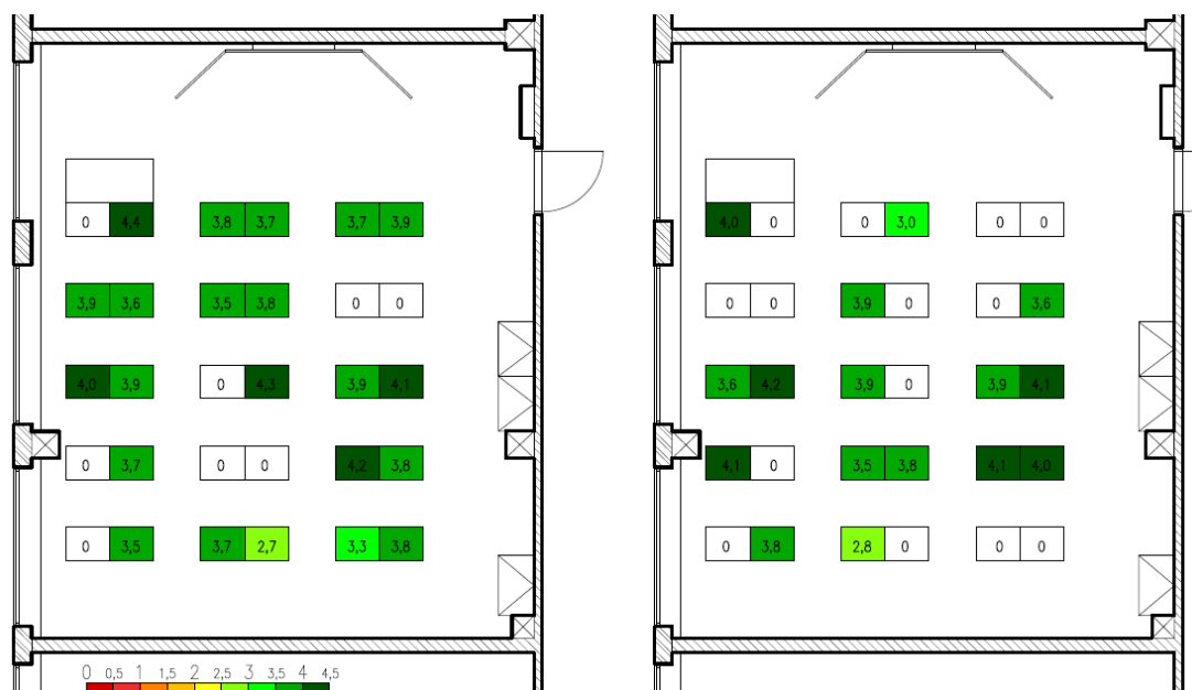
Obrázek 69: Porovnání spokojenosti žáků dle stran se světelnými podmínkami pro 1. a 2. dotazníkové šetření (červená – spíše nespokojeni; zelená – spíše spokojeni)
