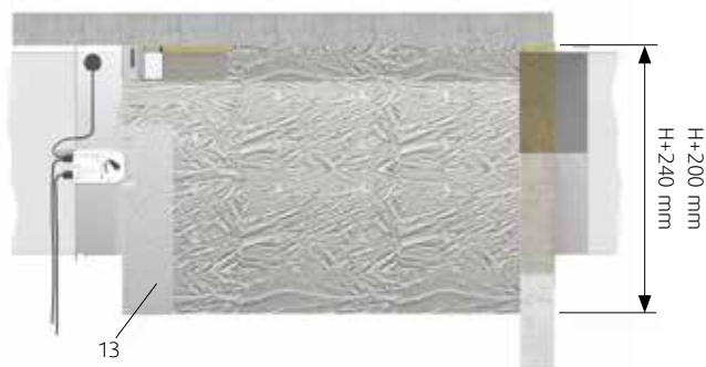
Obr. 36: Instalace mimo/na požárně dělící konstrukci v blízkosti stropu
