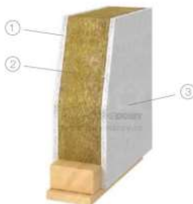
Obrázek 8: Schéma vnitřní nosné stěny, převzato z [18]
