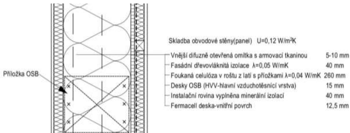
Obrázek 17: Skladba obvodové stěny, 2.varianta
