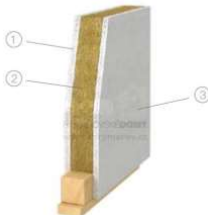
Obrázek 9: Schéma nenosné vnitřní stěny, převzato z [18]
