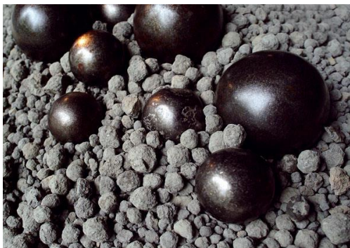
Obr. 2: Portlandský slínek v kulovém mlýnu (Matějka 2010).
