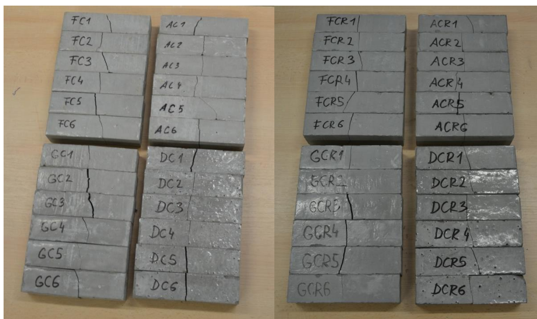
Obr. 43: Vzorky porušené křehkým lomem při tříbodovém ohybu.
