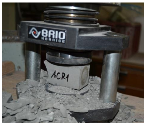
Obr. 30: Zkouška pevnosti v tlaku přístrojem EV 40.
