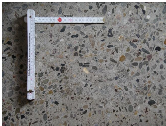
Obr. 7: Makrostruktura betonu, řez betonovou dlaždicí (Stroyres 2017).
