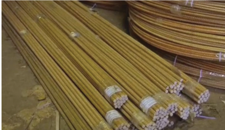
Obrázek 3: Kompozitní výztuž ze skelných vláken pojených polymerovou pryskyřicí. [12]
