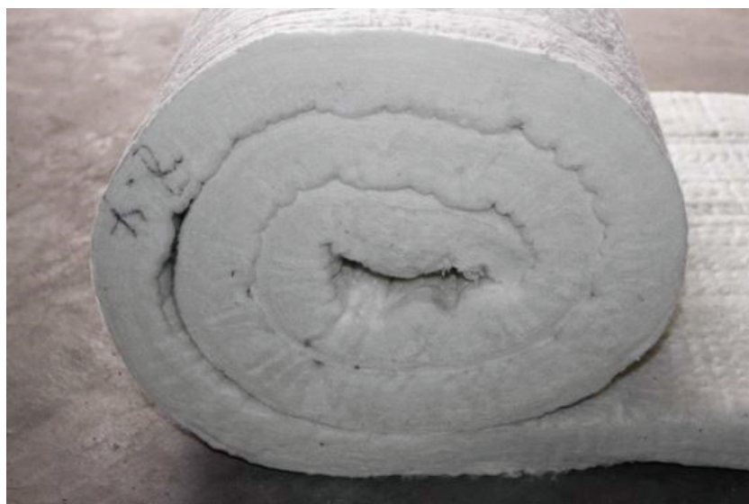
Obrázek 10: Keramická tepelná izolace pro izolace kotlů a pecí [38]
