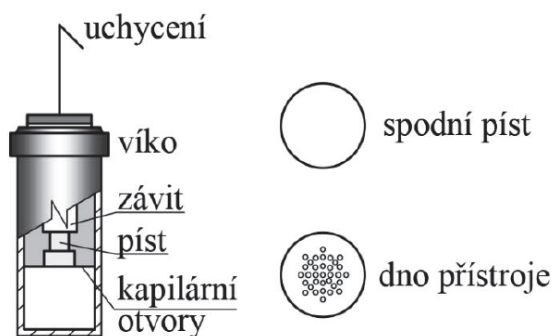
Obrázek 21: Vzorek pro metodu Packed Cell. [31]
