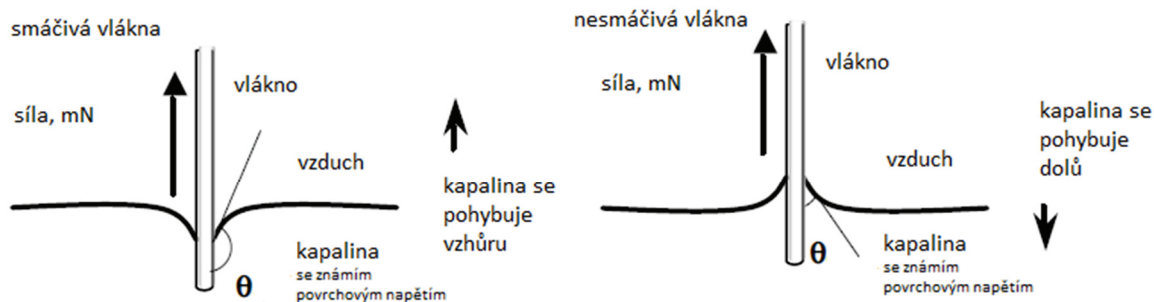
Obrázek 19: Měření kontaktního úhlu-Wilhemy metoda. [47]
