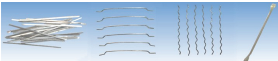
Obrázek 8: Různé tvary ocelových vláken. [20]
