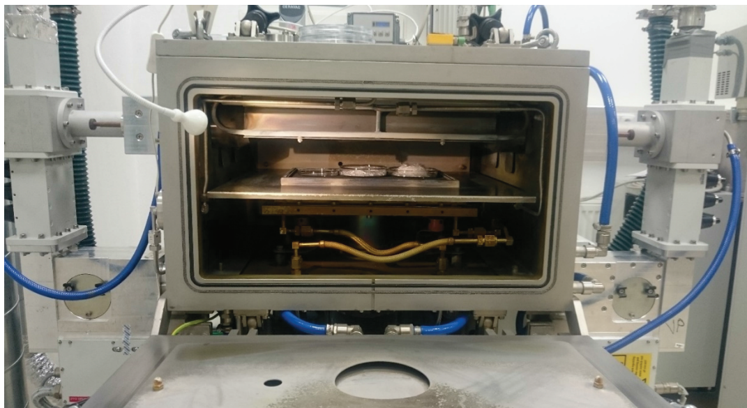
Obrázek 23: Komořina pro plazmatické modifikace přístroje ROTH&RAU AK 400
