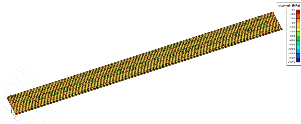
Obrázek 67 Průběh napětí na desce mostovky
