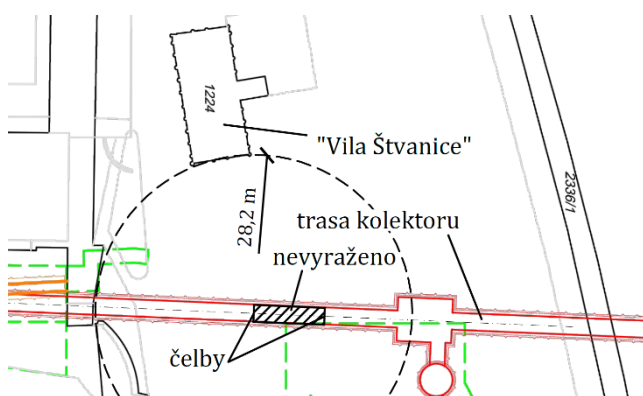
Obrázek č. 35: Situace sledovaného objektu a probíhajících ražeb
