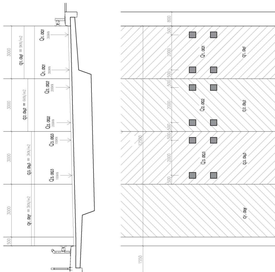
Obr. 3.12 Schéma zatížení dopravou LM1
