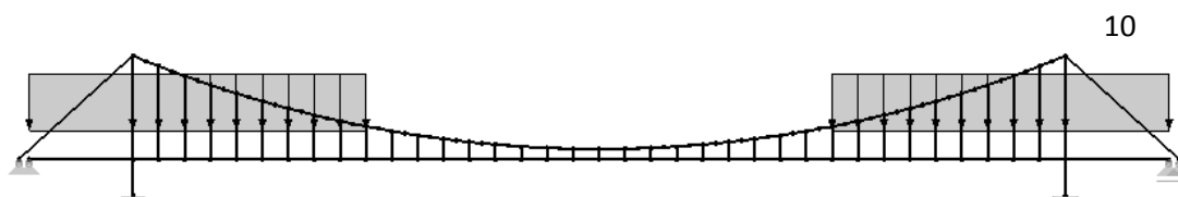
Obr. č.48 - Zatížení chodci v místě pylonů:
