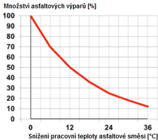
Obrázek 9: Vliv snížení teploty na množství asfaltových výparů [7]
