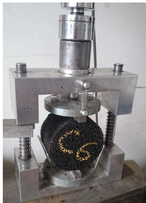
Obrázek 31: Zkouška stanovení pevnosti v příčném tahu
