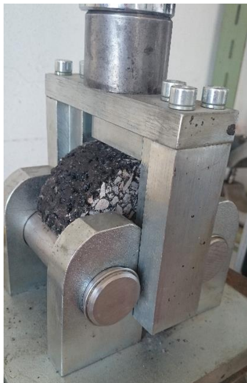
Obrázek 33: Zkouška šíření trhliny ohybem
