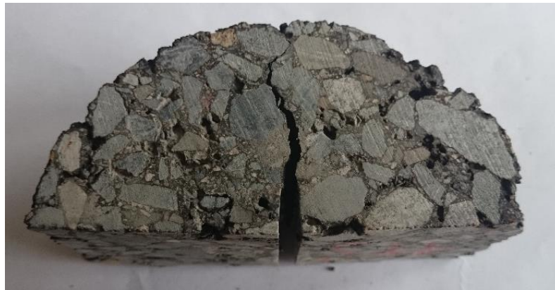
Obrázek 34: Zkušební těleso porušené trhlinou
