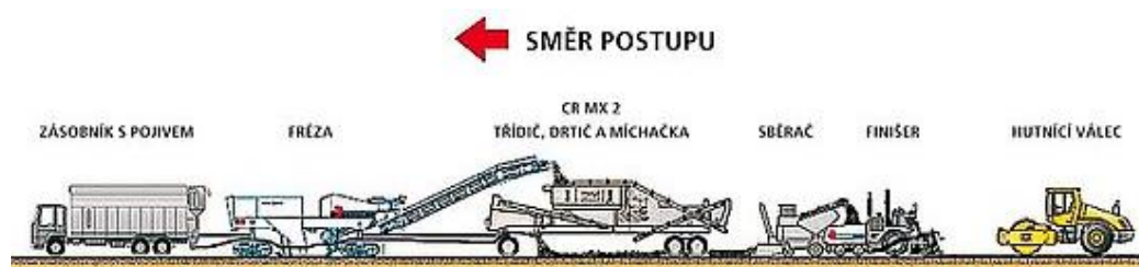
Obrázek 12: Schéma soupravy pro recyklaci za studena na místě [26]
