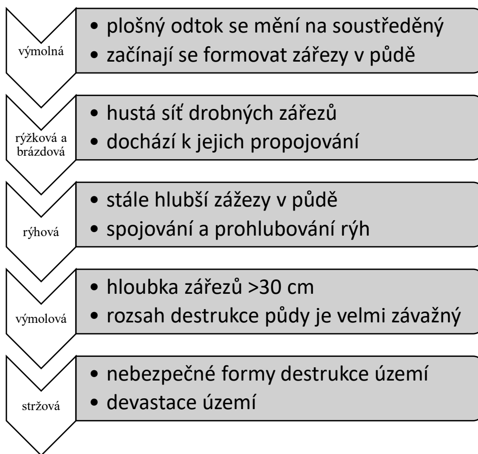
Obrázek 8: Stádia výmolné eroze Zdroj: autor
