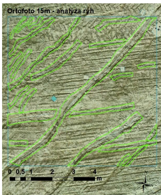
Obrázek 45 Analýza erozních rýh Vypracováno v programu ArcGIS Zdroj: ortofoto 5 m a DEM 15 m Podklad: DEM 15 m upravené HillShade
