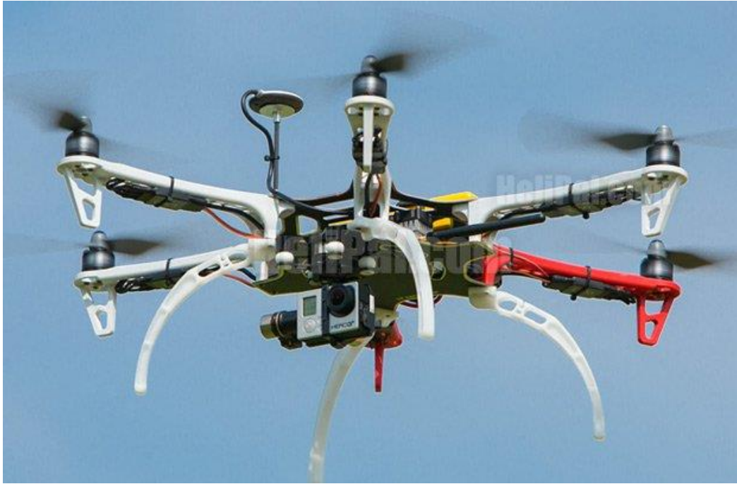
Obrázek 10: DJI F550 hexakoptér Zdroj [24]
