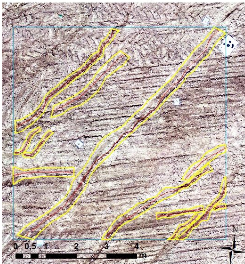
Obrázek 44: Analýza erozních rýh Vypracováno v programu ArcGIS Zdroj: ortofoto 5 m a 25 m Podklad: ortofoto 25 m neupravené
