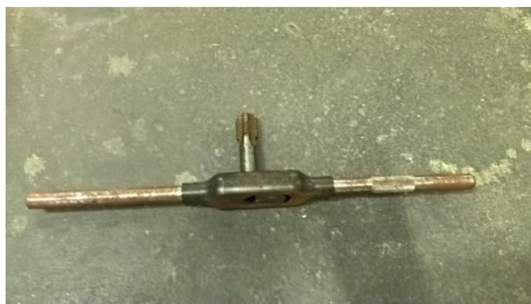
Obr. 8.4 – Závitník upevněný do vratidla [ŠVEJDOVÁ, Nikola. © 2017.]
