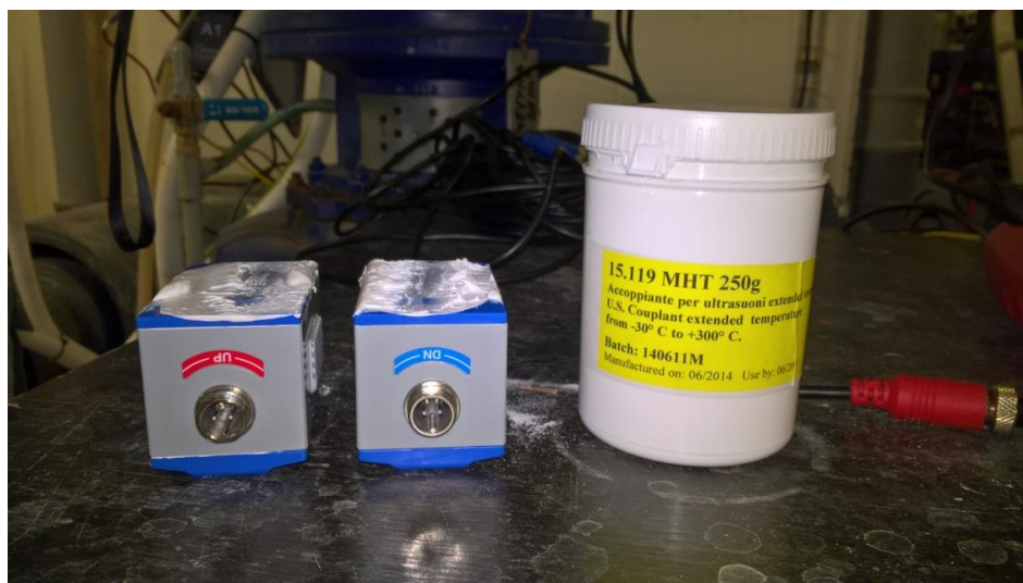
Obr. 8.10 – Magnetické snímače a speciální pasta [ŠVEJDOVÁ, Nikola. © 2017.]
