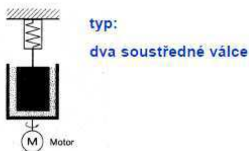
Obr. č. 8: Typ dva soustředěné válce [6]
