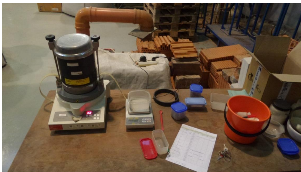
Obr.6.4 – Pracovní plocha v průběhu zrnitostní analýzy
