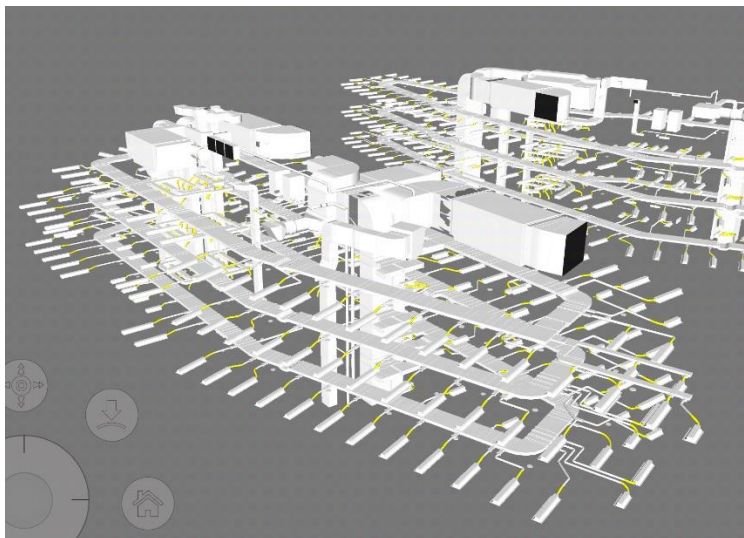
Obrázek 29: Model vzduchotechniky 5. NP až střecha
