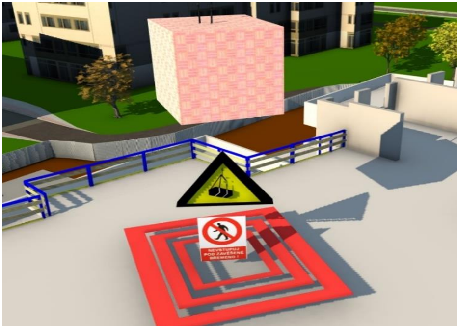
Obrázok 31 Nebezpečná zóna pod zaveseným bremenom, Zdroj vlastný
