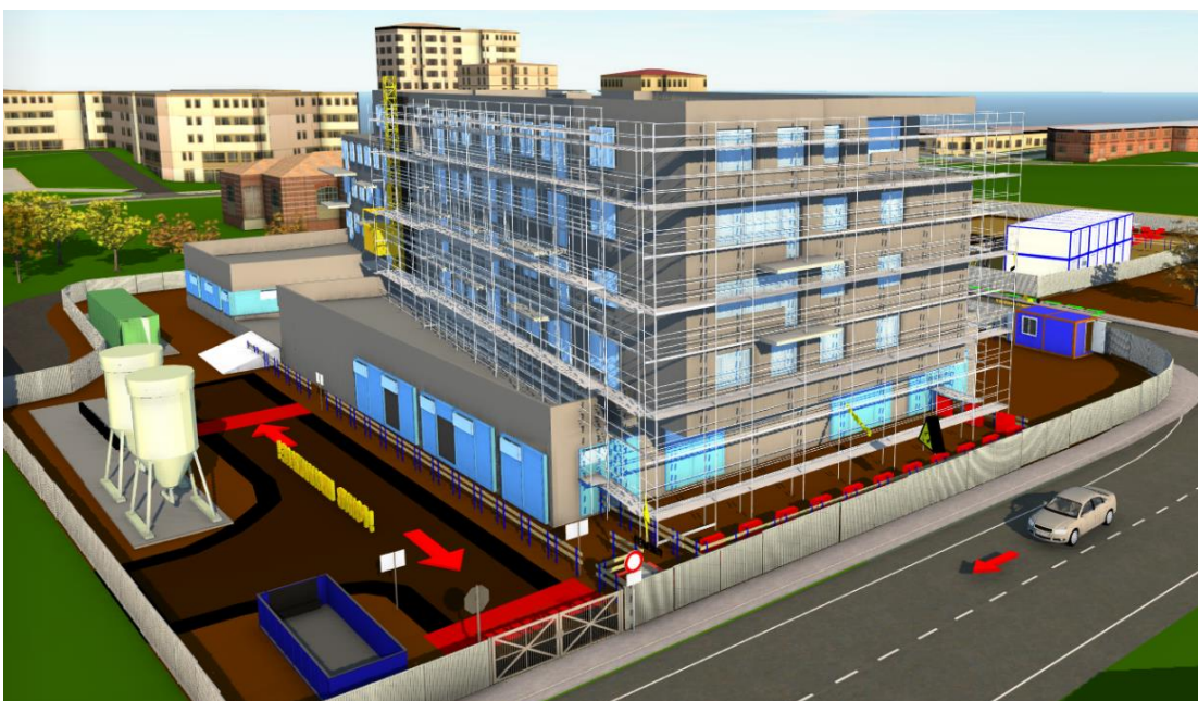
Obrázok 15 Model staveniska - dokončovacie práce, Zdroj vlastný
