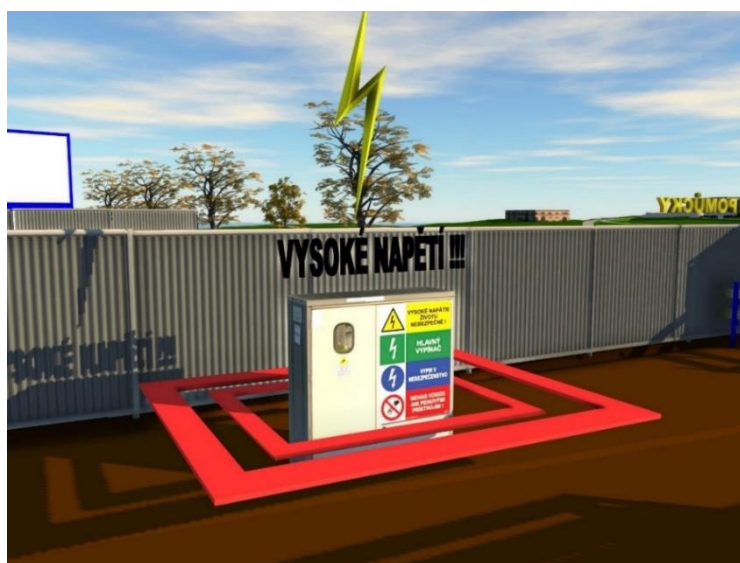
Obrázok 34 Vyznačená nebezpečná zóna elektrického zariadenia, Zdroj vlastný
