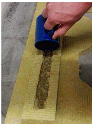
Obr. 29 - Kanálek z MV
