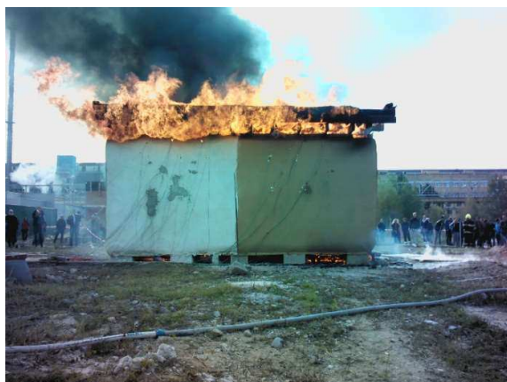
Obr. 44 - Běžný snímek termokamery ve 30. minutě požární zkoušky
