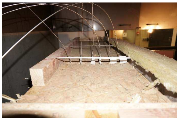
Obr. 60 - Z vrchu zabudovávané termočlánky
