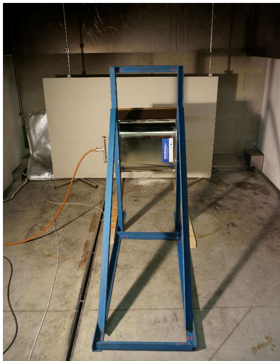
Obr. 56 - Ocelová konstrukce infrazářiče
