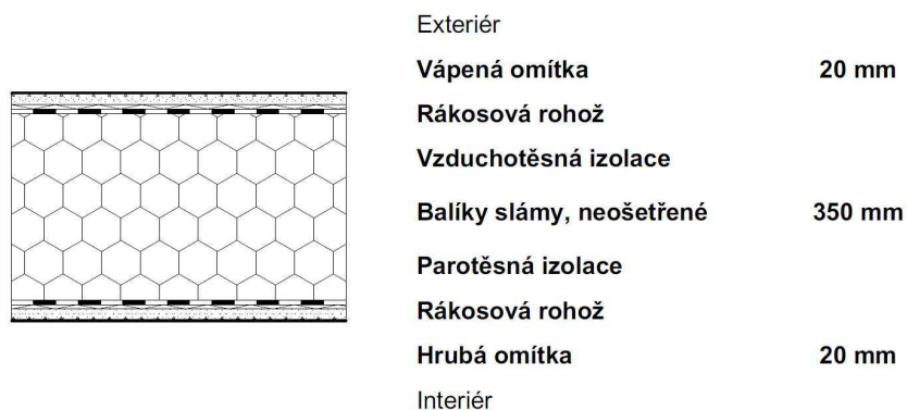
Obr. 6 - Skladba vzorku pro malo-rozměrový test
