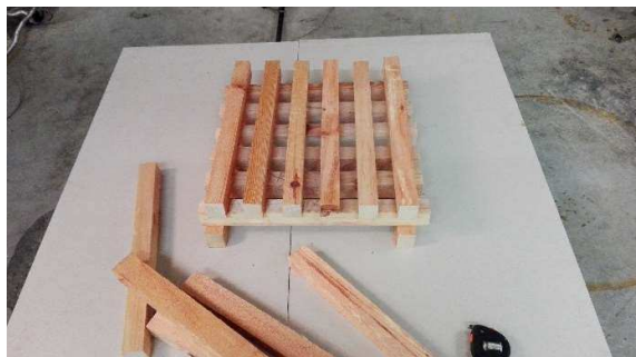
Obr. 74 - Založení požární hranice
