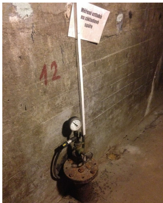
Obr. 5.10 Vrt 12 – měření vztlaku tenzometrem
