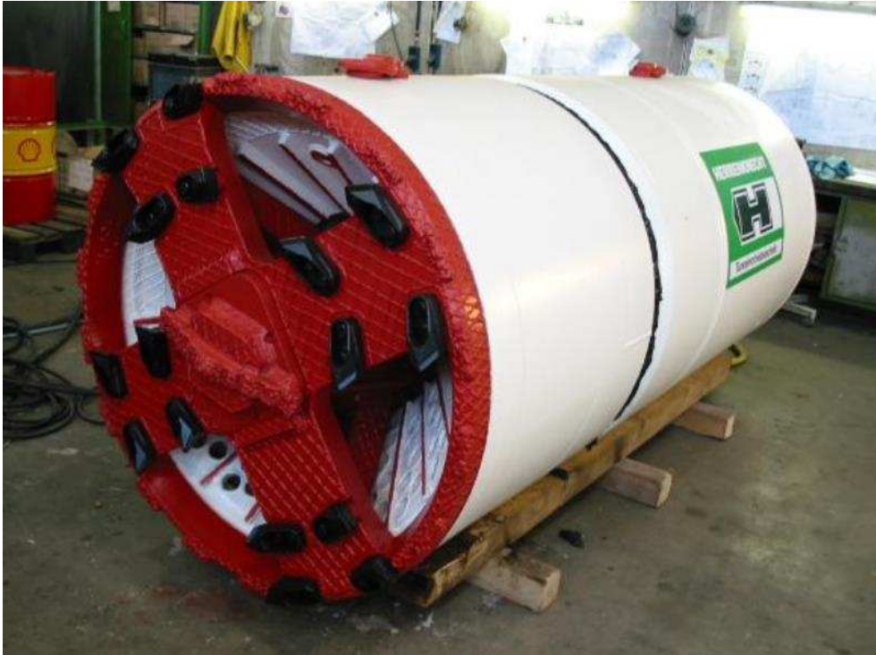
Obrázek 2.13 – Mikrotunelovací stroj AVN 1000XC se standartní vrtnou hlavou a vodním tryskovým systémem [29]
