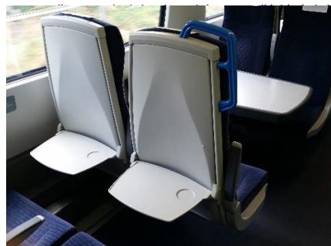
Obrázek 23: Siemens Desiro City Class 700 GTR. Malé sklopné stolky u sedadel neumožňují pohodlnou práci na počítači.
