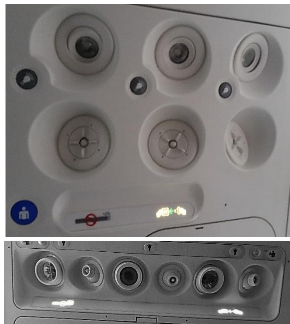
Obrázek 138: Boeing 737. Různé verze nadhlavních osobních světel a trysek umožňujících manuální regulaci proudění vzduchu z ventilace do prostoru sedadla cestujícího.
