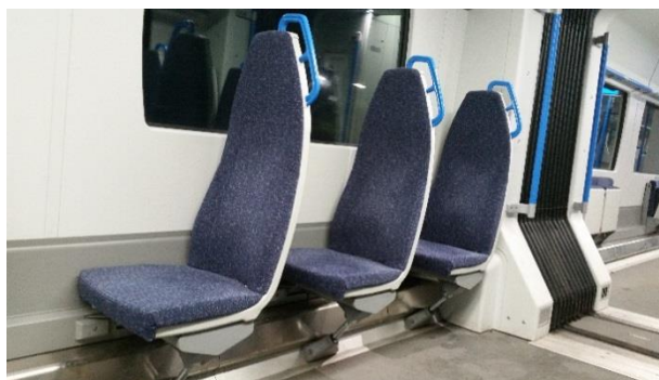
Obrázek 16: Siemens Desiro City Class 700 GTR. Sedadla uložená v postranních kolejnicích pro snadnou změnu interiérového uspořádání a snadný úklid podlahy. Pro cestujícího může být tento typ nohy sedadla omezující, protože mu omezuje prostor pro natažení nohou. Optimálnější by bylo sedadlo do bočnice vlaku zavěsit za bok zádového opěradla.
