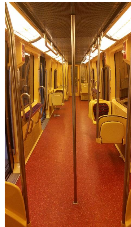
Obrázek 48: Siemens VAL208 Metro Toulouse. Maximální zavěšení prvků interiéru do stěn a jednodušší podlahy s jednoduchým zaoblením u stěn bez rohových spojů snižuje náročnost úklidu a údržby. Vůz je zároveň díky využití sedadel bez podpěr přehledný.
