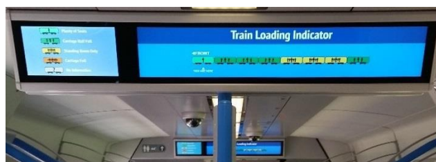
Obrázek 166: Siemens Desiro City Class 700 GTR. Vlak pomocí snímačů hmotnosti každého vozu odhaduje obsazenost každého vozidla ve vlaku a tuto informaci zobrazuje cestujícím na vnitřním vizuálním informačním systému spolu s jejich polohou ve vlaku, aby si mohli ve vlaku najít volnější vůz a nalézt místo k sezení. Toto řešení je dobrým začátkem, ale mnohem užitečnější by bylo, kdyby cestující měl tuto informaci již před příjezdem vlaku do stanice, případně by obsazenost každého vozidla mohla být signalizována pomocí LED semaforů na bočnici vlaku, aby cestující mohl jít do prostoru zastavení nevolnějších vozů ještě před úplným zastavením vozidla. Toto by bylo obzvláště užitečné pro skupiny, pro které je tato informace uvnitř vozidla již naprosto neužitečná. Zařízení zatím také nebere v potaz rozdíly mezi obsazením první a standardní třídy ve vlaku.
