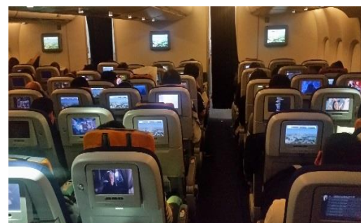
Obrázek 158: Airbus A380 Lufthansa. Každé sedadlo je vybaveno individuální obrazovkou palubního zábavního systému, který bývá většinou v letadlech ovládán ovladačem připojeným kabelem. Obrazovky bývají v průběhu dlouhých letů silně vytížené.
