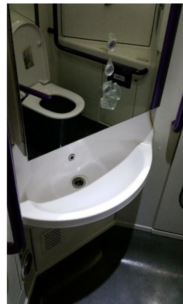
Obrázek 108: Siemens Desiro Heathrow Express. Ovládací prvky umyvadla jsou nejasné a autorovi se nepodařilo je spustit.
