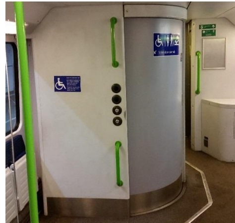
Obrázek 99: Univerzální toaleta s automatickými posuvnými dveřmi. Ovládání dveří je neintuitivně umístěno bohužel na druhé straně dveří, než kde se začnou otvírat a musí na toto umístění upozorňovat velké nálepky na dveřích. Na druhou stranu je toto umístění vhodné pro vozíčkáře, jelikož je v blízkosti místa pro umístění vozíku.
