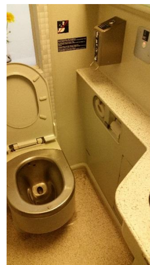
Obrázek 125: Siemens ICE 1 D DB. Toaletní mísa umístěná v dostatečné vzdálenosti od stěny. Toaleta je vybavená dávkovačem s desinfekčním prostředkem pro omytí prkénka před použitím.
