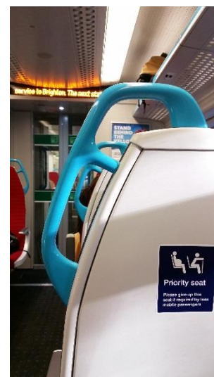
Obrázek 21: Bombardier Electrostar Gatwick Express. Madlo na opěradle sedadla. Tento typ se jeví jako vhodný, protože umožňuje pevný úchop v nejvyšším bodě sedadla a zároveň umožňuje držet se i menším cestujícím. Další výhodou je, že není opatřeno žádnými spárami a vroubkováním, kde by se držely nečistoty. Barevně se odlišuje od barvy sedadla pro lepší identifikaci madla slabozrakými cestujícími.
