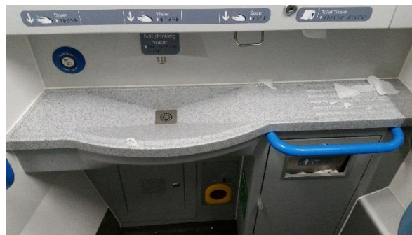
Obrázek 118: Siemens Desiro City Class 700 GTR. Umyvadlová deska je opatřena hranou a všechny části jsou uzpůsobeny pro odtékání vycákané vody do odtoku v umyvadle. Bohužel deska za a vedle umyvadla není vyrobena z jednoho dílu společně s umyvadlovou deskou, a tedy bude v ostrých rozích docházet k usazování nečistot a růstu plísní. Jelikož je nad umyvadlem převis, ve kterém se nachází sušák, kohoutek a dávkovač mýdla, tak je umyvadlo spíše zbytečně malé a neumožňuje pohodlné omytí tváře. Pokud by byl otvor do odpadkového koše umístěn shora v umyvadlové desce, nemuselo by docházet k tak velkému shromažďování zbytků papíru na desce.
