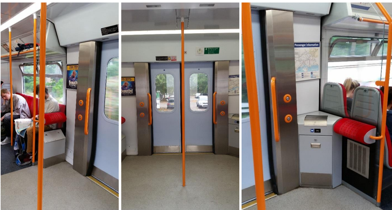
Obrázek 91: Vestibul městského vlaku ve kterém je poměrně vhodně využitý prostor okolo dveří, který umožňuje pohodlné stání a opírání cestujících bez toho, aby docházelo k blokování dveří. Opěrku by bylo spíše lepší umístit k bočnici vlaku, aby se cestující opíral zády o bočnici, ale pak by v nevyužitém rohu nemohla být takto vhodně umístěná nádoba na odpad.
