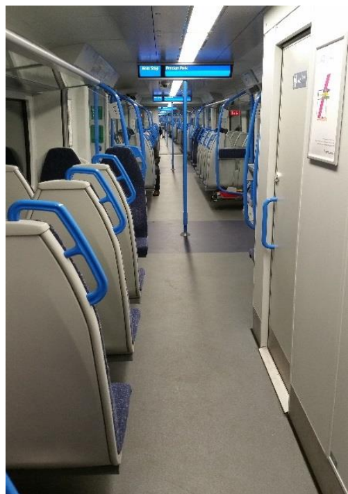
Obrázek 96: Siemens Desiro City Class 700 GTR. Standardní toaleta umístěná na jedné straně uličky v prostoru se sedadly pro cestující. Ve stísněném prostoru vlaku je vhodné standardní toaletu osadit posuvnými dveřmi, pokud je pro ně v interiéru místo. Doporučuje se použít ručně ovládané dveře, ale pokud je snaha o vytvoření bezdotové toalety, tak musejí mít pohon.
