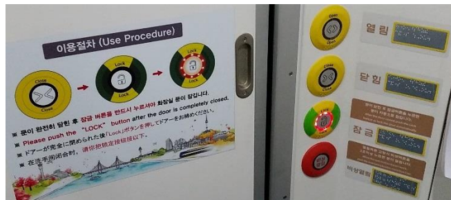
Obrázek 107: Tlačítka ovládání dveří jsou umístěna vhodně těsně vedle dveří. Pro zamykání je bohužel použito tlačítko, které bývá pro cestující matoucí. Z tohoto důvodu je funkce tlačítka vysvětlena na nálepce na dveřích. Nouzové tlačítko je bohužel stejného tvaru a ve stejném místě, jako tlačítka ovládání dveří. Toto není vhodné, protože může docházet k nechtěné aktivaci.
