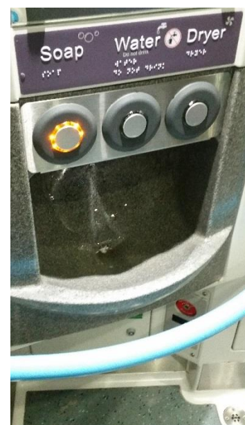
Obrázek 119: Systém umyvadla vše v jednom s tlačítkovým ovládním je sice pro dopravce jednoduchý a pravděpodobně i levný na použití, ale pro cestujícího není příliš komfortní a umožňuje pouze umytí rukou bez možnosti opláchnutí obličeje. Tento je navíc uživatelsky nepřívětivý v tom, že neumožní spuštění vody před stisknutím tlačítka dávkovače mýdla.
