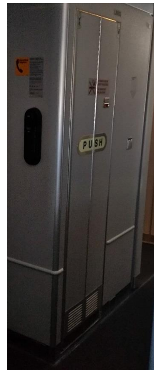
Obrázek 100: Airbus A380 Lufthansa. Ve stísněných interiérech letadel jsou na toaletách použity skládací dveře pro úsporu místa při jejich otvírání. Do stísněných míst ve vlaku může být toto použitelným řešením.
