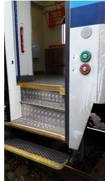
Obrázek 39: Nástup s kolem z výškové úrovně temene kolejnice po schodech do 820 mm širokých dveří (Strunz, et al., 2016) je pro cestujícího velmi nepohodlný a někdy až nebezpečný. Výstup je takřka nemožný. Přístup pro kola musí být úrovnový a dveře musejí být široké minimálně 1000 mm.
