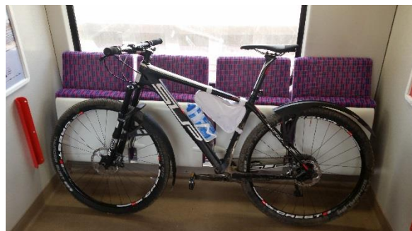
Obrázek 33: Víceúčelový prostor délky přibližně 2000 mm je na délku akorát vhodný pro postavení jednoho kola. Na toto kolo lze umístit ještě dvě další bez toho, aby docházelo k blokování uličky. Sklopná sedadla vhodně odsazují kolo od bočnice a umožňují jeho úsporné skladování v rovném a stojatém stavu i s 800 mm širokými řídítky a zároveň v přepravní špičce umožňují cestujícím sedět v tomto prostoru. Vhodné by bylo mezi dvojice sedadel umístit tyč, která by sloužila cestujícím k držení a cyklistům k zamčení rámu kola a tím jeho upevnění ve stojaté poloze. Každý víceúčelový prostor, kde se počítá s přepravou jízdních kol, by měl mít alespoň jeden 2000 mm dlouhý úsek bočnice osazen opěrkami místo sklopných sedadel, aby mimo špičky nedocházelo k zaplnění sklopných sedadel cestujícími a nebylo pak kam umístit kolo.
