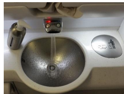
Obrázek 112: Airbus A380 Lufthansa. Kohoutek na toaletě umožňuje nastavit teplotu vody. Celá plocha okolo umyvadla je vyrobena z jednoho dílu pro omezení usazování nečistot a zatékání vody. Ručníky na sušení rukou jsou nad umyvadlem, takže voda z mokrých rukou kape do umyvadla. Umístění koše vedle umyvadla vybízí k doporučenému otření umyvadla ubrouskem použitým na ruce před jeho odhozením. Sprchové trysky na kohoutku mají šetřit vodou, ale nejsou doporučeny, jelikož dochází k rozstříkávání kapek vody a může docházet k roznášení bakterií.
