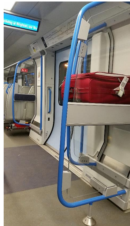
Obrázek 41: Siemens Desiro City Class 700 GTR. Nevhodné upevnění jediného komponentu do podlahy. Pokud si výrobce dal práci s upevněním sedadel, polic na zavazadla a ostatních komponentů do bočnic vlaku, není dobré toto porušit kvůli jedné noze jedné police, která zároveň slouží jako opěrka pro vozičkáře. Na druhou stranu je upevnění vhodně řešeno pomocí hladké konické krytky a nemělo by se tedy příliš zanášet nečistotami a jeho blízké okolí by mělo jít dobře čistit. Pod polici jsou zároveň vidět zákoutí, která půjdou špatně čistit a bude se v nich držet nepořádek.
