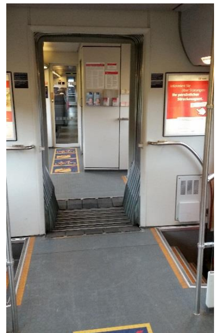
Obrázek 50: Adtranz RegioSwinger 612 D DB. Vozy propojené tlakotěsným přechodem, který umožňuje propojit vestibuly bez příček a dveří na konci vozu.
