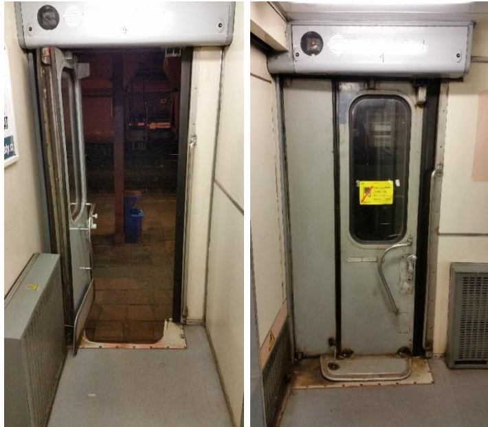
Obrázek 70: Moravskoslezská vagónka Studénka 460 CZ ČD. Mechanický způsob otevírání skládacích dveří za pomoci kliky. Takovýto způsob ovládnání je velmi nepříjemný a obtížný pro cestujícího. U tohoto vozidla je navíc doplněn o poměrně úzké dveře a velmi strmé a úzké schody a vozidlo je tedy velmi nepřívětivé pro osoby se sníženou schopností pohybu. Zavírání dveří je centrální bez detekce obsazení dveří a velmi prudké. Množství zákoutí v prostoru dveří zhoršuje možnost úklidu, a tudíž je tento prostor zanesen nánosy nečistot. Skládací dveře velmi špatně těsní a izolují, a tudíž do vozidla v zimě proniká studený vzduch, nečistoty a hluk. Zároveň se o dveře cestující poměrně jednoduše ušpiní. Jako vhodný prvek se jeví zakrytí schodů při uzavření dveří, tudíž nehrozí klopýtnutí cestujícího. Na druhou stranu tento kryt při otevření dveří zbytečně zužuje světelnou šířku dveří.
