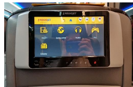
Obrázek 164: ASTRA Vagoane Calatori Bmpz A RJ. Obrazovka individuálního zábavního systému s dotykovým ovládním. Pro jednodušší úklid by bylo dobré mít displej překrytý sklem v rovině bez vystouplého rámečku, kde se mohou v rozích držet nečistoty.
