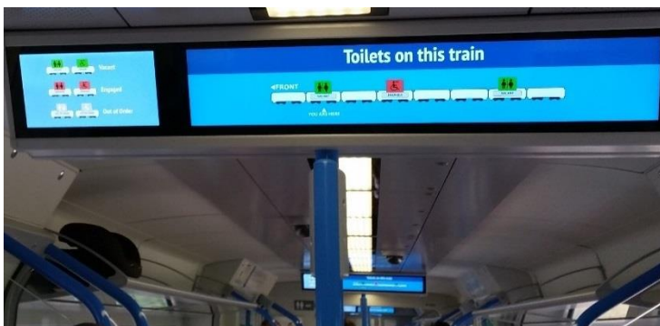
Obrázek 94: Siemens Desiro City Class 700 GTR. Vizuální informační systém ve vlaku je využit pro informování cestujících o poloze toalet, jejich obsazenosti a funkčnosti. Toto je velmi dobré řešení, protože cestující nemusí slepě procházet celý vlak a hledat funkční toaletu, ale může jít rovnou k toaletě, kterou mu systém ukáže jako funkční a volnou. V případě dělení toalet na pánské, dámské a sdílené je možno takovýmto způsobem informovat cestujícího, kde je nejbližší toaleta určená pro pohlaví se kterým se cestující ztotožňuje.
