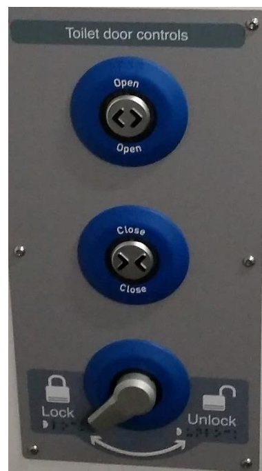
Obrázek 105: Jednoduchou záměnou tlačítka zámku za přepínač se elektronické uzamčení toalety stalo jednoduše pochopitelné pro cestující a srozumitelné i pro nevidomé. Na druhou stranu tlačítko otevření otevře dveře až po přestavení přepínače do odemčené polohy.
