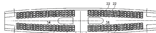
Obrázek 46: Dokumentace k patentu US 20090321568 A1. Mění se šířka uličky letadla by měla napomáhat plynulejšímu nástupu cestujících do letadla. Zdroj: (Dehn, et al., 2009)
