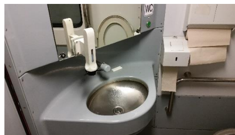
Obrázek 127: Moravskoslezská vagónka 843 CZ ČD. Nevhodné řešení prostoru umyvadla. Voda rozstříknutá na desku okolo umyvadla stéká na podlahu a vytváří pocit nečisté podlahy. Voda při sušení rukou papírovým ručníkem kape na podlahu a na toaletní papír, který bude pro dalšího cestujícího mokrý.
