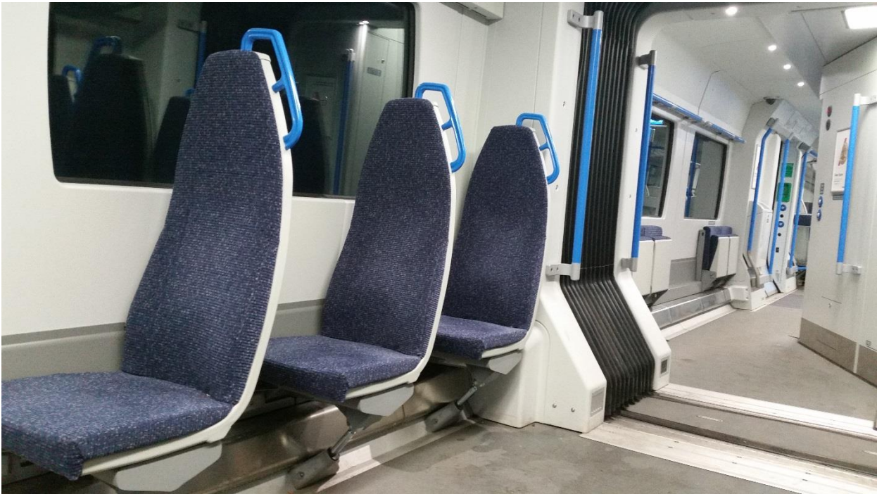
Obrázek 201: Ve vlaku jsou ve velkém množství použita jednotlivá sedadla v leteckém uspořádání, protože umožňují zvětšit prostor uličky pro jednodušší průchod a umožnění stání a opírání cestujících. Zároveň u sedadel v leteckém uspořádání nepřekáží nohy sedících v prostoru uličky. V úzkých místech vlaku je spíše lepší použít opěrky namísto sklopných sedadel.
