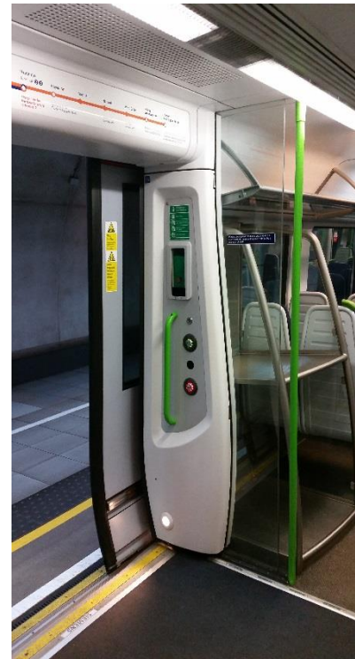
Obrázek 75: Siemens Desiro Heathrow Connect. Pomocí kombinace pevných prahů vyčnívajících před vozidlo a plastových ochranných prvků na nástupišti lze docílit minimalizaci mezery mezi vozidlem a nástupištěm i bez použití jakéhokoliv výsuvného prvku. Jelikož se jedná o letištní vlak, je eliminace mezery a schodu do vozidla velmi důležitá.
