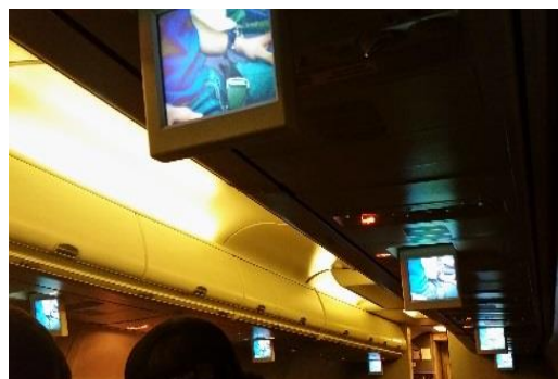
Obrázek 157: Boeing 737. Centrální obrazovky již inovovaného zábavního systému. Původně byly CRT obrazovky umístovány pod strop do uličky, ale technologie plochých monitorů umožnila je umístit nad sedadla a zasouvat do stropu.
