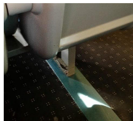
Obrázek 42: Bombardier Electrostar Southern Railway. Nečistoty drží s v záhybech nohy sedadla.
