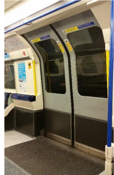
Obrázek 92: London Underground. Umístění opěrky na bočnici vedle dveří. Takovéto umístění opěrek se jeví jako optimální pro minimalizaci blokování dveří stojícími cestujícími. Lepším je ale opěrku umístit více do stěny a zúžit rám dveří, aby nedocházelo k opírání cestujících ve dveřích o rám dveří.
