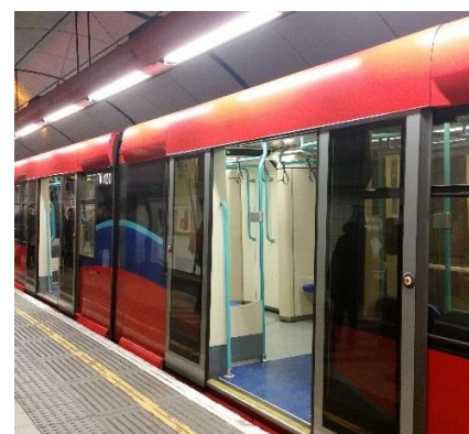
Obrázek 65: TfL Docklands Light Railway. Kontrastní provedení podlahové krytiny v prostoru dveří má zlepšit orientaci uvnitř vozu. Tlačítko ovládání dveří umístěné na vnějším okraji dveřních křídel podvědomě navádí čekající cestující k okraji dveří, aby byl umožněn průchod cestujícím, kteří vystupují.
