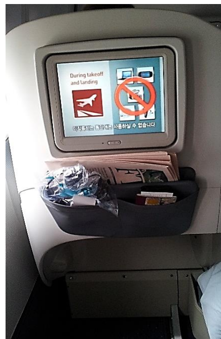
Obrázek 159: Boeing 747 Korean Air. Individuální obrazovky zábavního systému lze využít i pro informování cestujících. Tyto obrazovky jsou navíc vyrobeny tak, aby byl obraz viditelný pouze z úzkého rozpětí úhlu, a tudíž nerušil spolucestujícího.
