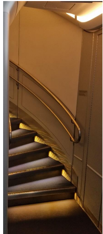
Obrázek 147: Airbus A380 Lufthansa. Nasvícení plochy schodu pro jejich zvýraznění je vhodným doplňkem a bylo by vhodné doplnit i do vlaků. Schody v potměných částech interiéru je vhodné pro slabě vidící cestující doplnit o LED pásky na hranách schodů, jako bývá v kinosálech.
