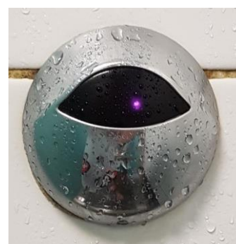
Obrázek 102: Jednoduchý vodotěsný bezkontaktní senzor, který při pohybu ruky v přibližně 10 cm vzdálenosti aktivuje připojený systém. Takovéto senzory by v případě dostatečného značení a popisu mohly ovládat většinu prvků toalety, od ovládání dveří, ovládání zámků až po splachování toalety.
