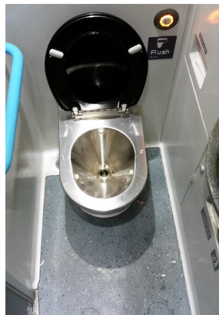
Obrázek 98: Bombardier Electrostar Gatwick Express. Standardní toaleta o velmi minimalistických rozměrech, kde nezůstává ani dostatek místa na plnohodnotné umyvadlo. Při otvírání dveří je cestující nucen se až opírat o mísu, aby dveře otevřel. Takovýto malý prostor musí být zároveň těžké uklízet. Ovládání splachování je vhodně umístěno v blízkosti mísy, kde by ho cestující očekával a nevyžaduje sklopení krytu.
