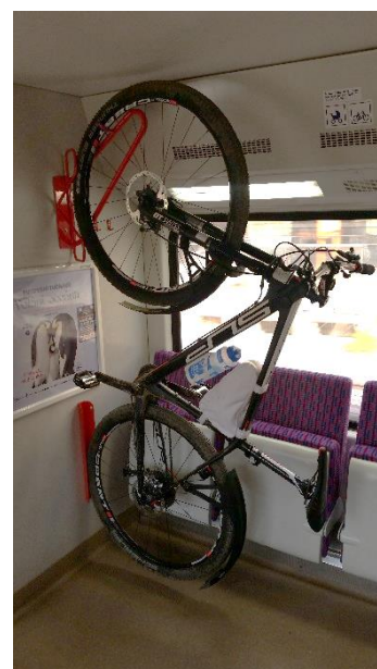
Obrázek 37: Svislé zavěšení kol na hák je pro cestující poměrně nepohodlné, ale pokud je vedle sebe zavěšeno více kol tak s přibývajícím počtem kol v řadě snižuje průměrnou šířku potřebnou pro každé kolo a zároveň umožňuje nezávislou manipulaci s každým kolem zvlášť. Pokud je ale hák umístěn samostatně, tak naopak zvětšuje prostor zabíraný kolem, a tedy námaha cestujícího nic pozitivního nepřináší.
