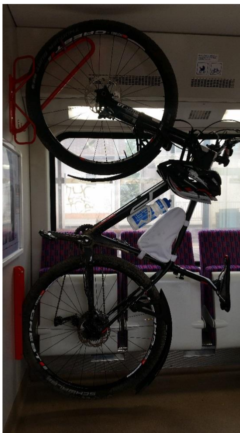
Obrázek 186: Kolo při zavěšení na bočnici zabírá přibližně metr šířky vozu – bylo by dobré je zavěsit po obou stranách vozu pro úsporu místa.
