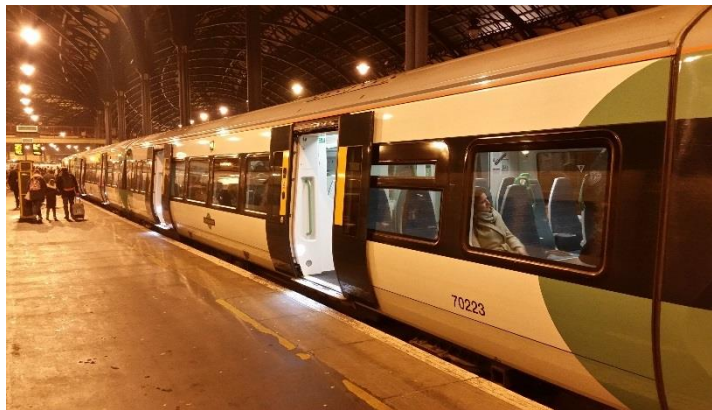
Obrázek 79: Bombardier Electrostar GTR/Southern Railway. Příměstský vlak se vyznačuje menším počtem velkých, dvoukřídlových dveří, které jsou jednoduché konstrukce pro rychlé zavírání a otvírání pro umožnění co nejkratších pobytů ve stanici. Dveře bohužel nejsou dostatečně zajištěny a při tlakových rázech dochází k jejich vibrování, což je slyšet uvnitř vozu.
