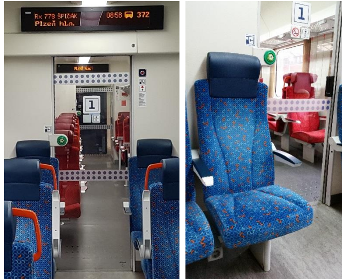
Obrázek 61: Pesa ABpee CZ ČD. Nevhodné umístění tlačítka dveří. Tlačítko je umístěno v blízkosti hlavy sedícího cestujícího a tomu nemusí být příjemné, když se procházející osoby musí rukou dotýkat okolí jeho hlavy. Tlačítko je zároveň umístěno na druhé straně rámu dveří, než kde se dveře začnou otvírat jako první, což je pro cestujícího matoucí. Tlačítko by bylo lepší umístit přímo na dveře, nejlépe doprostřed, nebo dveře ovládat senzorem bezkontaktně.
