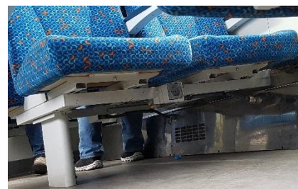
Obrázek 152: Pesa ABpee CZ ČD. Sedadlo druhé třídy se zásuvkou umístěnou poměrně hluboko pod sedadlem. Zásuvka je blízko cestujícímu a pro nabíjení mobilu, který má u sebe nepotřebuje příliš dlouhý kabel, ale zase ho nemůže mít položený na odkládací ploše pod oknem.
