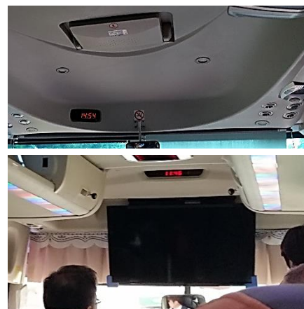
Obrázek 160: V přední části stropu uličky dálkových autobusů je umístěn plochý displej zábavního systému. Může být buď zaklápěcí, nebo pevně připevněn tak, aby nepřekážel při průchodu.
