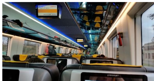
Obrázek 143: ASTRA Vagoane Calatori Bmpz A RJ. Vhodná kombinace bílého a barevného nepřímého osvětlení společně s různě barevným obložením interiéru vytváří příjemné prostředí pro odpočinek.
