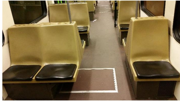
Obrázek 17: Jednoduchá městská sedadla určená pro krátkodobé sezení vyrobená s důrazem na jednoduchost úklidu.
