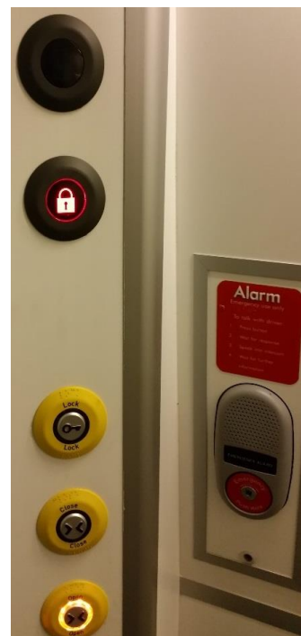
Obrázek 101: Pokud je pro uzamčení toalety použito tlačítko, je dobré mít intuitivní indikaci jak odemčených dveří, tak zamčených. V tomto případě se při odemčení rozsvítí zelená kontrolka s odemčeným zámkem. Bohužel vizuální signalizace je nevhodná pro nevidomé cestující. Nouzové tlačítko je tvarově a barevně odlišné od zbytku ovládacích tlačítek, což je správně. Tlačítka dveří by měla být dle TSI PRM seřazena s tlačítkem otvírání nahoře. (Evropská komise, 2014)
