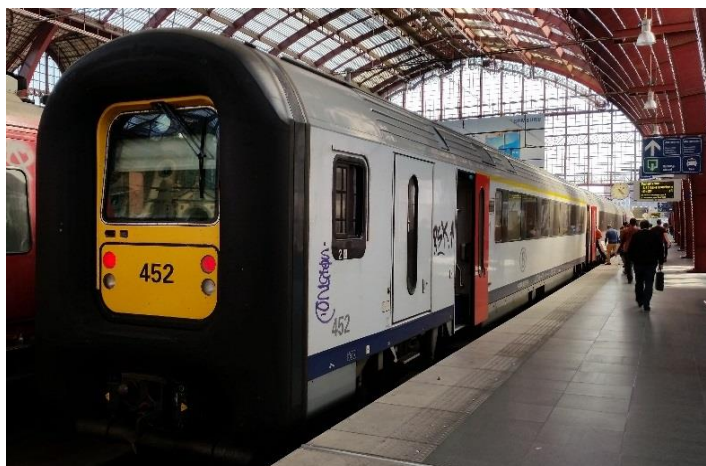
Obrázek 80: Standardní rozmístění dveří u dálkových vlaků - malé jednokřídlé dveře umístěné na koncích vozů.
