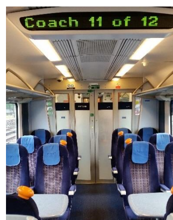
Obrázek 58: Siemens Desiro SouthWest Trains. Dvoukřídlé dveře se od sebe pohybují rychleji a dříve umožní průchod osobě. Zde je příčka bohužel nevhodně zatemněna, a tudíž snižuje nepřehlednost interiéru a neumožňuje náhled do prostoru za dveřmi před otevřením.
