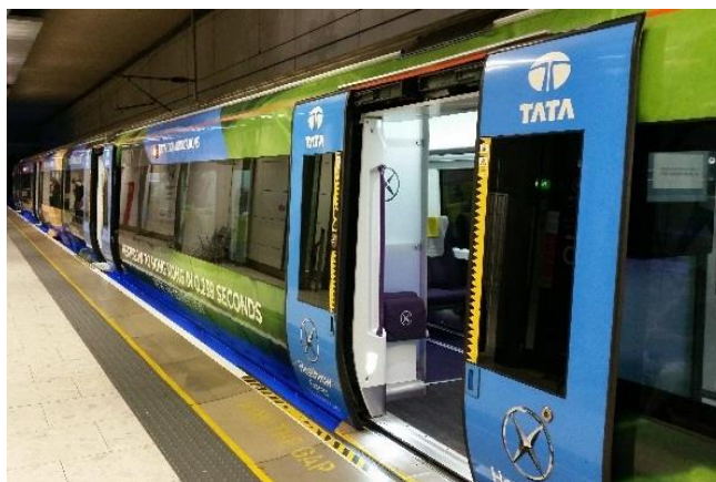
Obrázek 62: Siemens Desiro Heathrow Express. Velké dvoukřídlé exteriérové dveře s poměrně prostorným a designově sladěným vestibulem se sklopnými sedadly, která zároveň umožňují opírání krátkodobých cestujících. Plně úrovnňový přístup do vagonu bez schodů a bez mezery mezi nástupištěm a vozidlem je nutností pro moderní letištní vlak, jelikož lze očekávat pohyb cestujících s velkým množstvím kufřů na kolečkách. Pocit elegance a luxusu je spoluvytvářen i pomocí podsvícení nástupiště a vozidla modrou barvou. Nový cestující je tímto vlakem doslova ohromen, což by měl být cílem všech železničních dopravců, kteří si na svůj provoz potřebují vydělat pomocí přilákání stálých zákazníků. I když je vozidlo opatřeno celovozovou reklamou, stále jsou dveře provedeny kontrastně pro lepší orientaci cestujících. Vnější ovládací tlačítko dveří je bohužel umístěno uprostřed dveří, a tudíž na nástupišti nepomáhá podvědomě vytvářet volnou uličku pro výstup.
