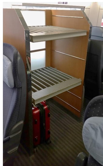
Obrázek 29: Siemens ICE1 D DB. Police na zavazadla v postarší dálkové jednotce je sice vhodně umístěna mezi sedadly a má doporučené tři úrovně, ale z dnešního pohledu již neobstojí. Není prosklená pro lepší přehled o zavazadlech a lepší by bylo nahradit jednu takto velkou polici více menšími stojany rozmístěnými na více místech ve voze pro vyšší pocit bezpečí zavazadla. Zároveň je dobré mít ve stojanu police o různých výškách pro efektivní promutí různě velkých zavazadel a mít police mírně skloněné směrem ke stěně.
