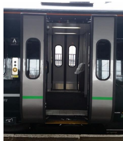
Obrázek 82: GreatWestern Railway. Dvoukřídlové dveře, které jsou užší a odpovídají šíři dveří vhodné pro dálkový vlak, kde není nutná víceprúdová výměna cestujících. Tyto dveře se zároveň jeví, jako dostatečně široké i pro cestující s kolem. Dvě křídla dveří umožňují rychlejší rozevírání průchodu, a tedy zkracují dobu do výstupu prvního cestujícího po započeti sekvence otvírání dveří.
