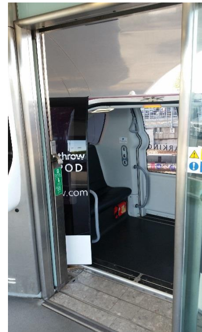
Obrázek 76: Heathrow POD. Autonomní vozidlo zastavuje u nástupiště tak přesně, že mezi vozidlem a hranou nástupiště nevzniká skoro žádná mezera i bez použití výsuvných prvků.
