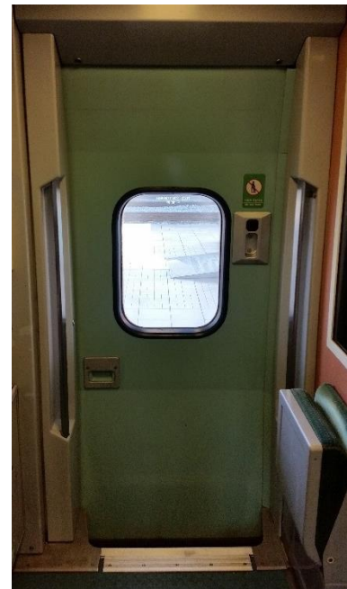
Obrázek 83: Rotem KTX KORAIL. Jednokřídlové dveře vysokorychlostní jednotky jsou tužší, pevnější a pevněji zajištěné, což vede k lepšímu odolávání tlakovým rázům a zvyšuje komfort cestujících.
