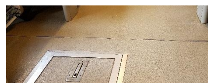
Obrázek 44: Lepený spoj podlahové krytiny, který se postupně používáním vozidla pomalu trhá. Lepší je nemít spoje na frekventovaných místech. Pokud dopravce neudrží své vlaky se zájmem o jejich co nejdelší životnost a neopraví trhlinu v linoleu hned na jejím počátku, bude postupně docházet k dalšímu odtrhávání krytiny, jejímu trvalému poškození a zatékání tekutin pod podlahovou krytinu a degradaci částí vozidla.
