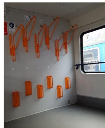
Obrázek 38: Stupňování držáků na kola umožňuje do stejného prostoru naskládat více kol, jelikož se řídítka nesetkávají v jedné úrovni. Efektivita využití prostoru se zvyšuje s počtem kol vedle sebe, je tedy lepší kola umístit v dlouhé řadě na bočnici než takto na vnitřní příčku. V případě umístění držáků na bočnici se při snaze o úsporu místa dá umístit kola naproti sobě na obě bočnice a jejich případné natočení směrem ke dveřím zjednoduší nástup a výstup s kolem (ale zúží uličku mezi koly).
