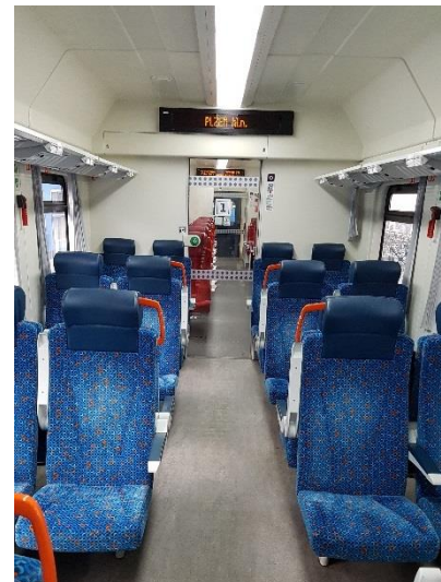
Obrázek 140: Pesa ABpee CZ ČD. Silné přímé bílé osvětlení bez automatické regulace jasu v kombinaci s bílým obložením a světlou lesklou podlahou způsobují u cestujících v tomto vozidle pocit přesevětlenosti interiéru (obzvláště ve večerních hodinách). Takto svítící interiér u tohoto dálkového vozidla neumožňuje příjemně odpočívat.
