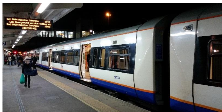
Obrázek 78: Bombardier Electrostar London Overground. Městský vlak, který je adaptovaný z platformy příměstských lehkých vlaků Turbostar a Electrostar. Z důvodu využití jednotné platformy má každý vůz pouze dvoje dvoukřídlové dveře v každé bočnici. Tento nedostatek se vozidlo snaží kompenzovat poměrně prázdným uspořádáním interiéru, které by mělo umožňovat lepší proudění cestujících v salonu a vestibulu. Dveře jsou jednoduchého konceptu a pouze se zasouvají do bočnice vozu. Každé dveře mají pouze jedno tlačítko na vnějším rámu – bylo by lepší, aby bylo tlačítko na každé straně rámu dveří pro zvýšení komfortu cestujících.
