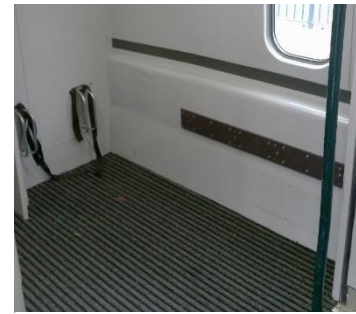
Obrázek 35: Stojany na kola jsou při vodorovném stání kola spíše zbytečné a snižují využití prostoru. Kolo je lepší opřít o opěrky podél bočnice a připevnit zámkem k madlu – takto se do stejného prostoru mohou vejít až tři kola.
