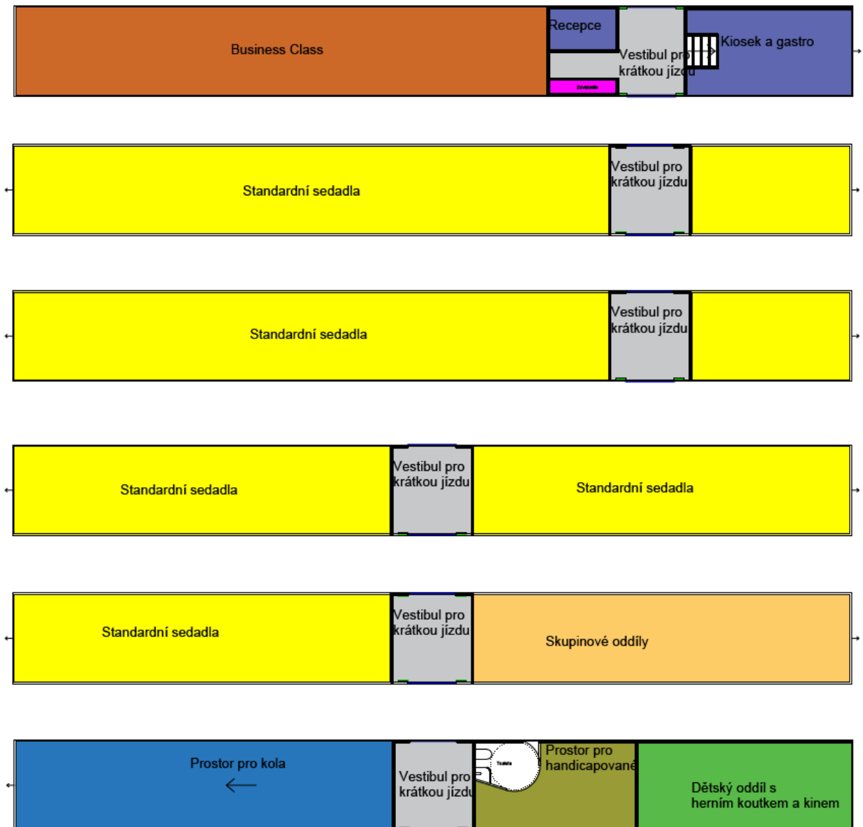
Obrázek 188: Navrhované rozložení funkčních oddílů v dálkovém vlaku InterRegio.
