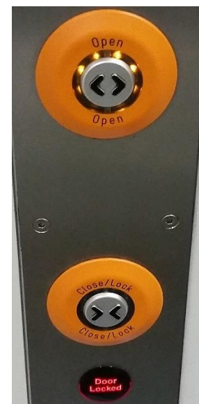
Obrázek 59: Tlačítka interiérových dveří. Tlačítka mají hmatové prvky pro rozeznání nevidomým cestujícím, ale v jejich záhybech se budou usazovat nečistoty, které budou provozem narůstat bez plnohodnotné možnosti vyčištění.
