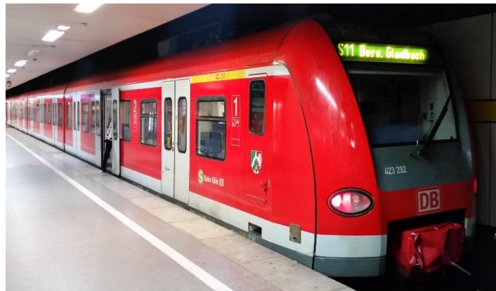
Obrázek 77: 423 D DB S-Bahn Köln. Městský vlak se vyznačuje velkým množstvím velkých, dvoukřídlových dveří, které se rychle otvírají a automaticky zavírají a umožňují rychlou výměnu cestujících pro dosažení krátkých pobytů ve stanicích.
