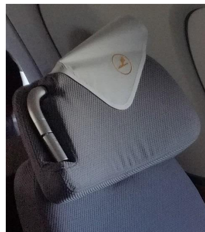
Obrázek 150: Airbus A380 Lufthansa Business Class. Individuální lampička umístěná v opěrce sedadla. Zde se jedná o poměrně flexibilní řešení umožňující nastavení směru světla cestujícím, ale zároveň je takovéto řešení náchylnější na poškození, proto není vhodné pro použití ve třídě Economy.
