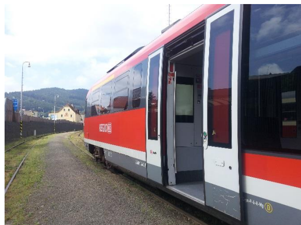
Obrázek 73: Siemens Desiro Classic D DB. Velké předsvuné dveře umožňují jednoduchý nástup se zavazadly a rychlou výměnu cestujících. Chybějící výsuvný schod dělá toto nízkopodlažní vozidlo velmi těžko přístupné z nástupišť, která jsou hluboko pod úrovní podlahy vozidla.
