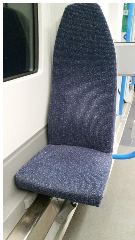
Obrázek 135: Siemens Desiro City Class 700 GTR. Topný kanál většinou ve voze zabírá poměrně velký prostor a omezuje nohy cestujícího sedícího u okna. V tomto případě zabírají lišty a kanál topení skoro polovinu šířky sedáku. Lepším řešením vytápění vozu je pomocí systému HVAC, případně pomocí plošného vytápění podlahy.
