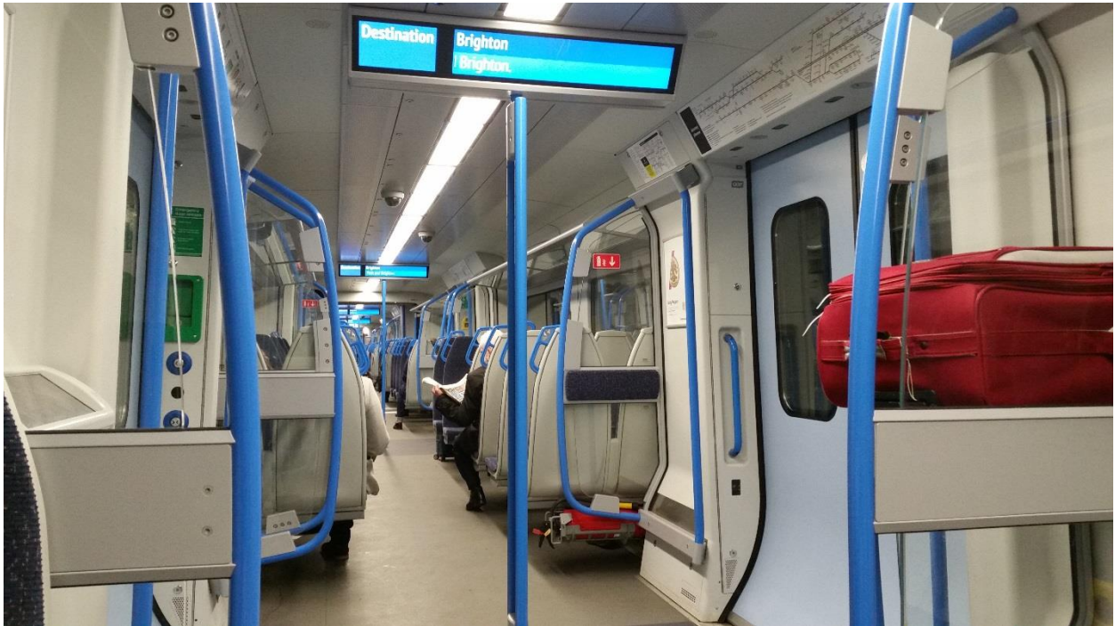
Obrázek 199: Prostor okolo velkých dveří by měl být co nejvolnější pro umožnění pohodlného stání krátkodobých cestujících a snaze o omezení blokování vystupujících a nastupujících cestujících.
