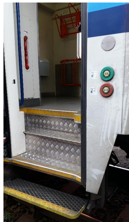
Obrázek 66: Pesa ABpee CZ ČD. Na boční vozu jsou umístěny ovládací prvky dveří. Umístění ovládacích prvků, akustické signalizace a jejich kontrastnost s bočními prvky vozu odpovídá TSI PRM. Bohužel z důvodu nevyhovujícího nástupiště v místě focení výška nad hranou nástupiště neodpovídá hodnotám v TSI PRM. Ovládací prvky se cestou špiní a bohužel pak dochází ke špinění cestujících při použití – toto by šlo vyřešit bezkontaktními ovládacími prvky. Schody do vozu jsou poměrně strmé a zhoršují jeho dostupnost pro strážní osoby, děti a cestující se zdravotními omezeními. Schody jsou opatřeny kontrastními prvky dle TSI PRM pro lepší periferní viditelnost a zlepšení orientace osob se zhoršeným zrakem.
