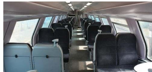
Obrázek 10: Bombardier M6 B SNCB. Okna a sedadla jsou na každé straně uličky odsunuta o půl rozteče čtyřsedadla, což odstraňuje úzká hrdla v místech opěradel sedadel a umožňuje cestujícím se lépe při průchodu vozem držet madle na opěradlech sedadel. Zdroj: (Jens1503, 2008)
