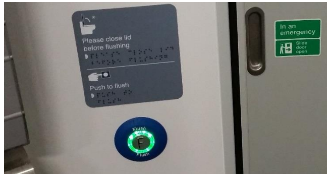
Obrázek 106: Tlačítko splachování je umístěno vedle dveří ze záchodu, kde by člověk intuitivně spíše předpokládal umístění tlačítek na ovládání dveří. Do blízkosti dveří je lepší umístit tlačítka ovládání dveří, jelikož zde by je cestující (i nevidomý) intuitivně hledal. Tlačítko splachování může být na opačné straně mísy.
