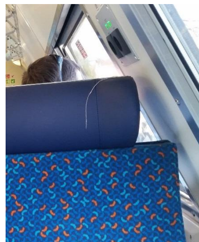
Obrázek 153: Pars Nova Bdmteeo CZ ČD. Umístění zásuvek na bočnici v blízkosti hlavy cestujícího mu nemusí být příjemné, obzvláště pokud je v zásuvce zapojen tuhý a rovný napájecí kabel od notebooku. U tohoto vozidla se ale z důvodu přítomnosti otvíracích oken pravděpodobně jiné řešení nenabízelo.
