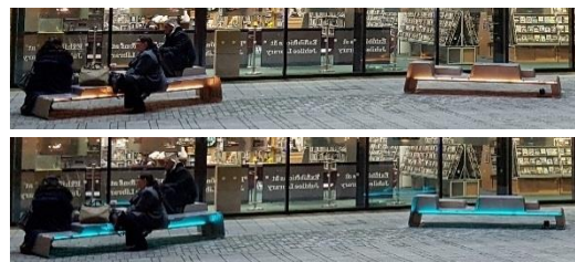
Obrázek 145: Barevné LED pásy použité pro barevné nasvícení laviček. Mění se barvy osvětlení by šlo využít i v interiéru vozidla pro zpříjemnění cesty.
