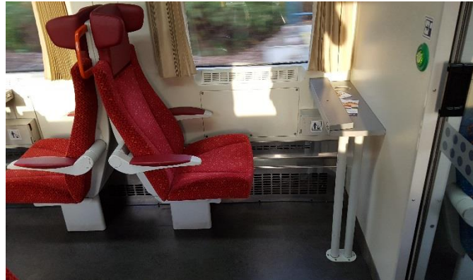
Obrázek 2: Pesa ABpee CZ ČD. Sedadlo první třídy s výhledem na vnitřní přičku a s nedosažitelným stolkem. Toto je naprosto nevhodné řešení, jelikož cestující by neměl koukat přímo do interiérové přičky, protože může takovýto prostor působit nepříjemně a klaustrofobicky. Stolek je příliš daleko na umožnění práce, využitelný je maximálně na odložení počítače/tabletu/mobilu při sledování filmů a seriálů. Pokud by bylo sedadlo umístěno obráceně, cestující by měl navíc extra prostor pro nohy pod sedadlem před. Úklid se v tomto vozidle provádí hůře, jelikož je podlaha plná zbytečných sloupků a koš je zbytečně schovaná pod stolem daleko od uličky.
