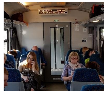
Obrázek 57: Jednokřídlé posuvné dveře. Křídlo dveří je velké a bude se velmi dlouho otvírat. V tomto případě by bylo lepší mít dvě křídla dveří uzavírající se proti sobě pro rychlejší otevření průchodu pro osobu. Zároveň je dobré umožnit dveřím signalizovat, že se již mohou začít zavírat (tlačítko zavírání).
