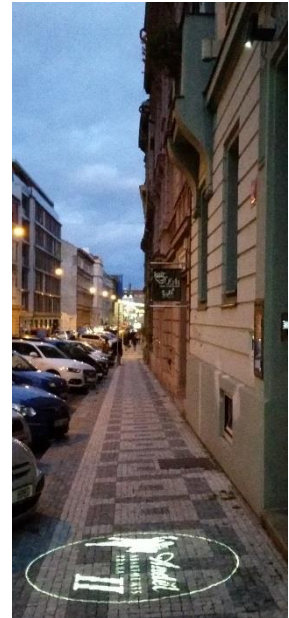
Obrázek 60: Laser zobrazující obrázek a nápis na podlaze může být použit v blízkosti interiérových dveří pro informování cestujících o velikosti prostoru, kde bude jejich přítomnost registrována a dveře se otevřou. Po registraci je blikáním možné informovat cestující o tom, že jejich přítomnost byla systémem registrována a systém pracuje.
