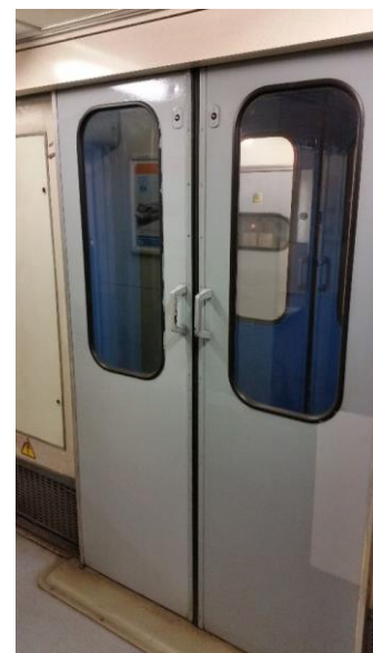
Obrázek 53: Moravskoslezská vagónka Studénka 460 CZ ČD. Průchod mezi vozy tvořený ocelovým můstkem a návalky nechrání před hlukem a tepelně neizoluje. Je tedy nutné ho osadit příčkovými dveřmi. V tomto případě se jedná o ručně ovládané posuvné dveře se kterými se velmi špatně manipuluje, jsou pro cestujícího nekomfortní, zasekávají se a špatně izolují.
