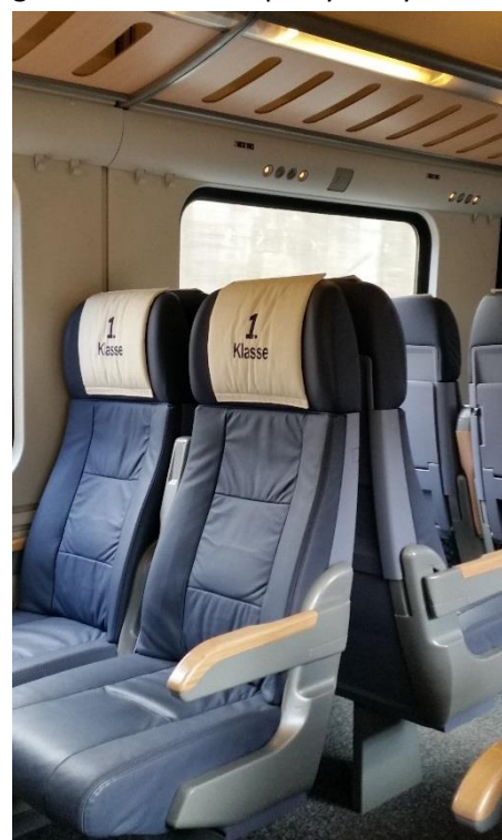
Obrázek 149: Adtranz RegioSwinger 612 D DB. Sedadla první třídy s lampičkami individuálního osvětlení umístěnými na bočnici nad sedadlem i s ovládáním. Sedadla jsou pohodlná, vybavena plnohodnotnými stoly pro práci a sklopným opěradlem.
