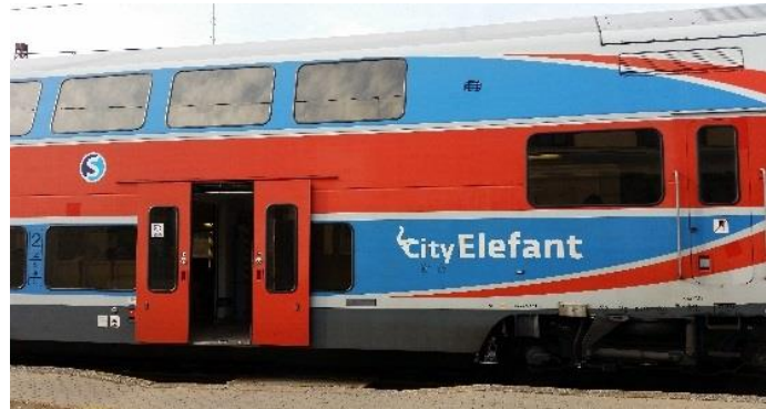
Obrázek 84: ČKD Vagonka 471 CityElefant CZ ČD. Vozidlo určené pro zastávkové vlaky je vybaveno dvoukřídlymi dveřmi, které by měly umožnit rychlejší výměnu cestujících. Bohužel každé křídlo dveří je ovládáno odděleně pomocí jiného tlačítka, které je navíc v interiéru každé umístěno na opačné straně vestibulu. Toto řešení velmi zpomaluje výměnu cestujících a snižuje jejich komfort. Zároveň je vnější tlačítko umístěno uprostřed dveří, což může vést k tomu, že je prostor dveří více blokován čekajícími cestujícími, než kdyby byla tlačítka umístěna na vnějším okraji dveří. Vozidlo je koncipováno jako nízkopodlažní bez vstupních schodů, ovšem nevhodně nízká nástupiště a chybějící výsuvný schod dělají v zobrazené poloze toto vozidlo prakticky nedosažitelné pro starší osoby a rodiče s malými dětmi.
