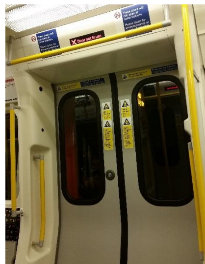
Obrázek 63: Dveře s automatickou signalizací neotevření dveří ve stanici (z důvodu krátkých nástupišť). Na 21. století a dobu levných a všudypřítomných LED svítidel se takovýto minimalistický informační systém jeví, jako poměrně slabý. Lepší by bylo rovnou nasvítit celé dveře červeně pomocí množství LED pásů a pomocí blikajících šipek informovat cestujícího, kde najde nejbližší funkční dveře.
