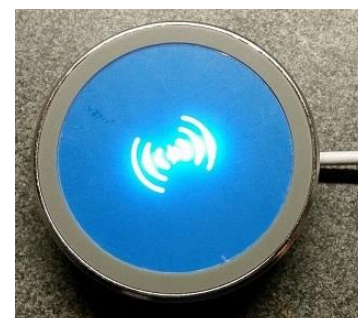
Obrázek 156: Podložka umožňující indukční nabíjení mobilních telefonů. Zařízení by šlo zabudovat do stolů ve vlaku a napájet z rozvodu 5 V.
