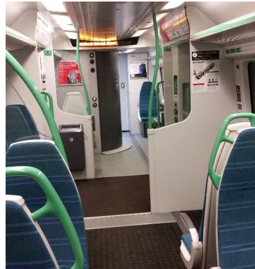
Obrázek 95: Bombardier Electrostar Southern Railway. Univerzální toaleta umístěná ve víceúčelovém prostoru. Toaleta má vedle dveří umístěna oddělená tlačítka otvírání a zavírání. Bohužel se tato tlačítka nenalézají v blízkosti místa, kde se dveře začínají otvírat, což je pro cestujícího mnohem intuitivnější než na druhé straně. Při takovémto umístění to naopak může být pohodlnější pro cestujícího na vozíku, protože k toaletě přijíždí z této strany. Na stěně u stropu toaleta viditelně indikuje volnost, obsazenost a případnou nefunkčnost.
