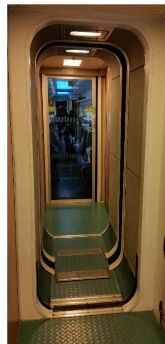
Obrázek 54: Rotem KTX KORAIL. Tlakotěsný průchod mezi vozidly. Neosazení dveřmi je výhodou, ale průchod je lepší, když je prostornější.
