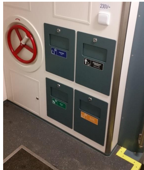
Obrázek 93: Koše na třídění odpadu v prostoru vestibulu dálkového vlaku. Koše na tříděný odpad by měly být umístěny v každém vestibulu a co nejbarevněji od sebe odlišeny.
