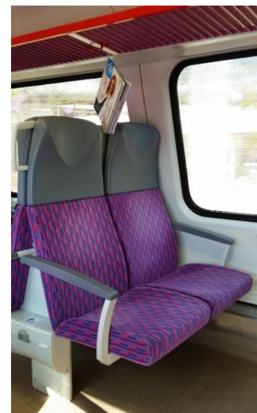
Obrázek 171: V případě chybějících držáků na tiskoviny v interiéru je dopravce nucen se uchýlovat k nouzovým řešením a například vybavovat palubní časopisy poutky pro zavěšení na háček.
