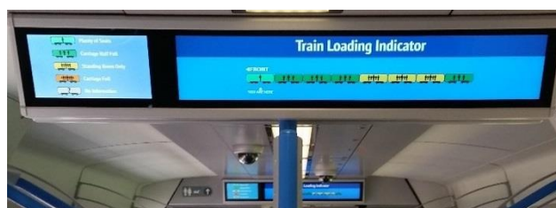
Obrázek 67: Siemens Desiro City Class 700 GTR. Vlak pomocí snímačů hmotnosti každého vozu odhaduje obsazenost každého vozu ve vlaku a tuto informaci zobrazuje cestujícím na vnitřním vizuálním informačním systému spolu s jejich polohou ve vlaku, aby si mohli ve vlaku najít volnější vůz a nalézt místo k sezení. Toto řešení je dobrým začátkem, ale mnohem užitečnější by bylo, kdyby cestující měl tuto informaci již před příjezdem vlaku do stanice, případně by obsazenost každého vozu mohla být signalizována pomocí LED semaforů na boční straně vozu, aby cestující mohl jít do prostoru zastavení nejvolnějších vozů ještě před úplným zastavením vozu. Toto by bylo obzvláště užitečné pro skupiny, pro které je tato informace uvnitř vozu již naprosto neúčinná. Zařízení zatím také nebere v potaz rozdíly mezi obsazením první a standardní třídy ve vlaku.
