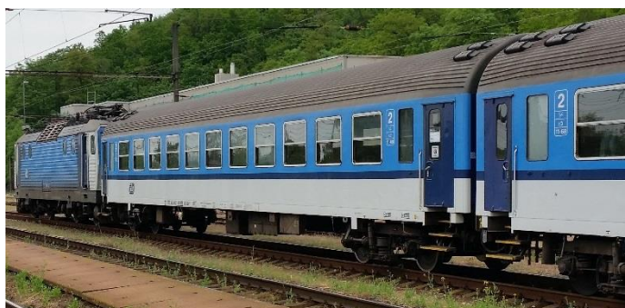
Obrázek 71: Bdt CZ ČD. Dálkové vozidlo osazeno jednokřídlými zalamovacími dveřmi manuálně ovládanými cestujícími pomocí kliky. Toto ovládání dveří je pro cestujícího velmi nepohodlné a ve spojení s velmi strmými a vysokými schody zároveň poměrně obtížné k otevření. Pokud cestující nastupuje s velkým zavazadlem, nemá ve dveřích příliš místa pro pohodlnou manipulaci a nástup.
