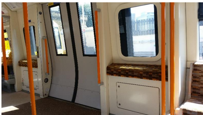
Obrázek 89: Bombardier Electrostar London Overground. Opěrky umožňující polostání vhodně zakomponované do stěny vozidla tak, aby nepřekážely při průchodu cestujících. Takovéto opěrky by bylo vhodné umístit i do vestibulu dálkových vozidel, ale v odlišné poloze vhodné pro uspořádání dálkových vozidel a případně i menší.
