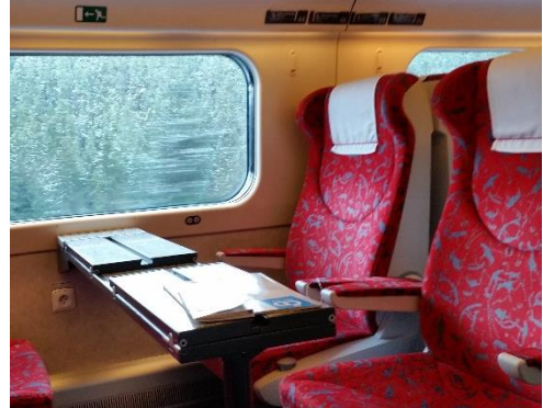
Obrázek 24: Alstom Pendolino 680 CZ ČD. Plnohodnotný stůl s výklopnou částí pro pohodlnou práci na počítači a snadnější přístup.
