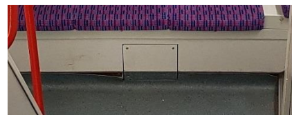
Obrázek 43: Mezi podlahou a stěnou je krytina položena jednoduše a se zaoblením, což umožňuje jednodušší a kvalitnější úklid. Bohužel je tato výhoda smazána zásahy do celistvosti podlahové krytiny, kde dochází k odlepování. Pokud dopravce neudrží své vlaky se zájmem o jejich co nejdelší životnost a nepřilepí odlepený kousek lina hned na počátku odlepování, bude postupně docházet k odtrhávání krytiny dále, jejímu trvalému poškození a zatékání tekutin pod podlahovou krytinu a degradaci částí vozidla.
