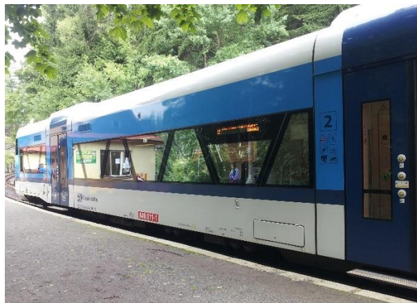
Obrázek 74: Stadler RegioShuttle II 840 CZ ČD. Výsuvné schody na vozidle zjednodušují cestujícím nástup z nástupišť, která nejsou rovňe s podlahou vozidla, ale prodlužují dobu potřebnou pro odblokování a zablokování dveří.
