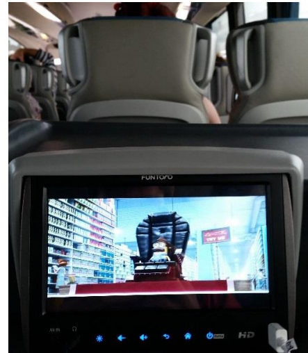
Obrázek 162: Individuální obrazovka zábavního systému s dotykovým ovládním umístěná u sedadla v autobuse.
