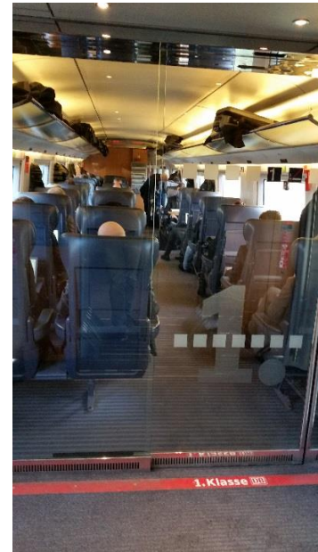
Obrázek 55: Siemens Velaro ICE 3 D DB. Plně prosklené příčky mezi vestibulem a salonek zvyšují světlost vestibulu, zvyšují přehlednost a pocit bezpečí ve vlaku a zároveň částečně izolují hluk a snižují výměnu vzduchu. Pro příčkové dveře je lepší použít posuvné dveře dvoukřídlé, protože u nich dochází k rychlejšímu rozevírání otvoru ve dveřích a mechanicky jsou křídla lehčí.
