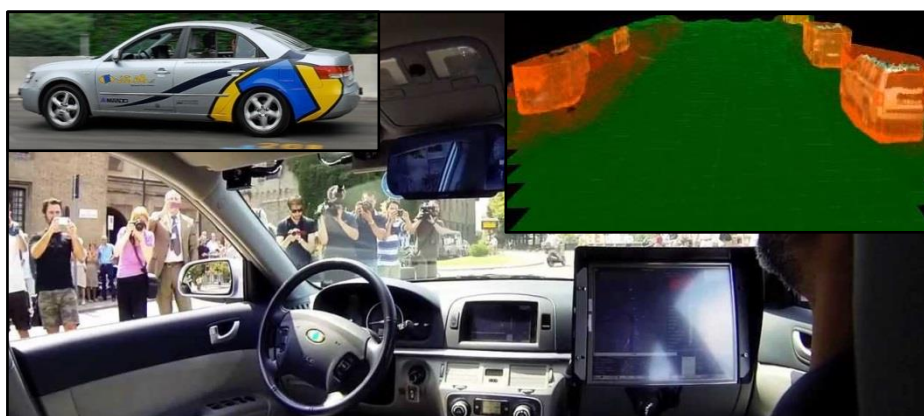
Obrázek 5 Vozidlo BRAiVE jedoucí bez řidiče, ukázka rozpoznávání objektů v pravém horním rohu [8]
