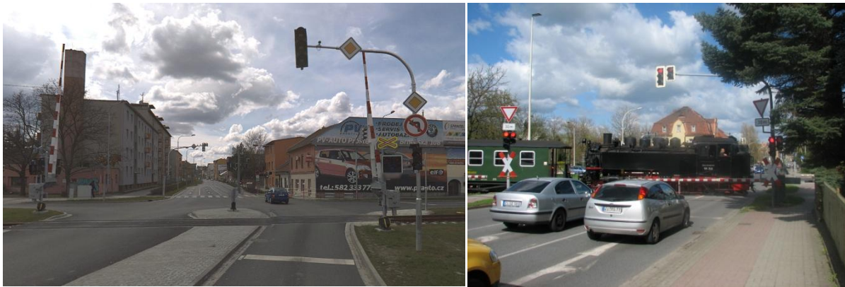
Obr. 28 : Rozdíl mezi umístěním PZZ a SSZ před přejezdem v ČR (vlevo) a v Německu (vpravo)
