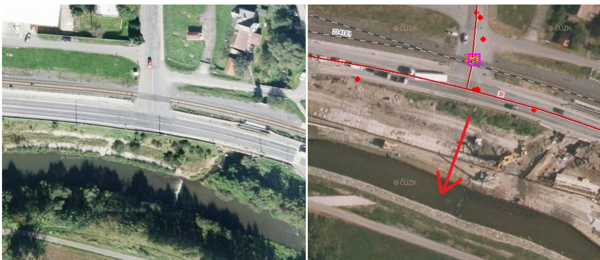
Obr. 26: Přeložka koryta řeky Bečvy v délce 238 m (zdroj: mapy.cz, jdvm.cz)
