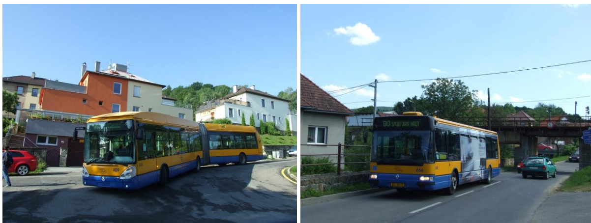
Obr. 2 - díky unifikaci karosérií ve vozovém parku je často na první pohled obtížné trolejbus od autobusu rozlišit. Vlevo trolejbus Škoda 25Tr jedoucí na pomocný dieselagregát ke gymnáziu Lesní čtvrť, vpravo autobus Karosa CityBus na zvláštní školní lince 90 z Želechovic do Lužkovic
