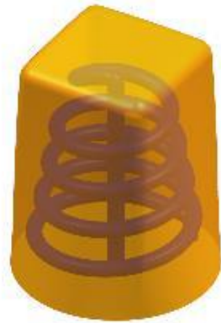
Obr. 22 Příklad dílce s vnitřními kanály [13]
