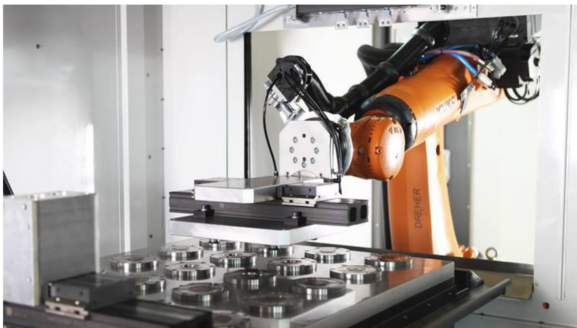
Obr. 15 Robot KUKA KR QUANTEC, manipulující s paletami[8]
