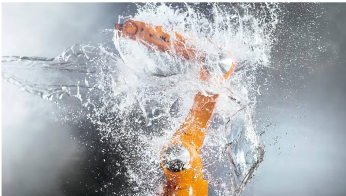
Obr. 12 Voděodolný robot KR AGILUS se stupněm krytí IP67 [8]
