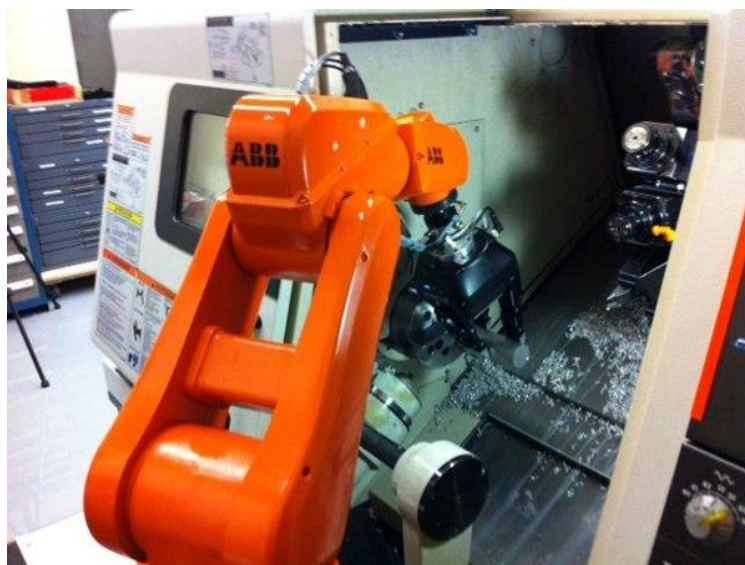
Obr. 8 Spolupráce robotu ABB a soustruhu [4]
