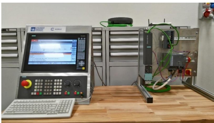
Obr. 68 Ovládací (vpravo) a řídicí stojany pro komponenty Siemens SINUMERIK [35]
