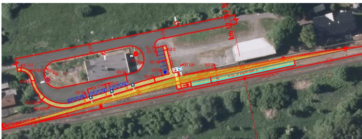
Obrázek 18 - Roz. trojúhelníky na centrálním úrovňovém přechodu (znázorněny žlutě) Rozhledové trojúhelníky vyhovují normě, centrální přechod bude vybaven pouze výstražnými tabulemi dle přílohy D.
