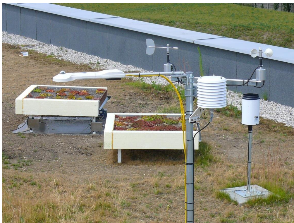
Obr. 3: Meteorologická stanice a dva vážené segmenty umístěné na zelené střechě experimentálního centra UCEEB dne 25. června 2015.
