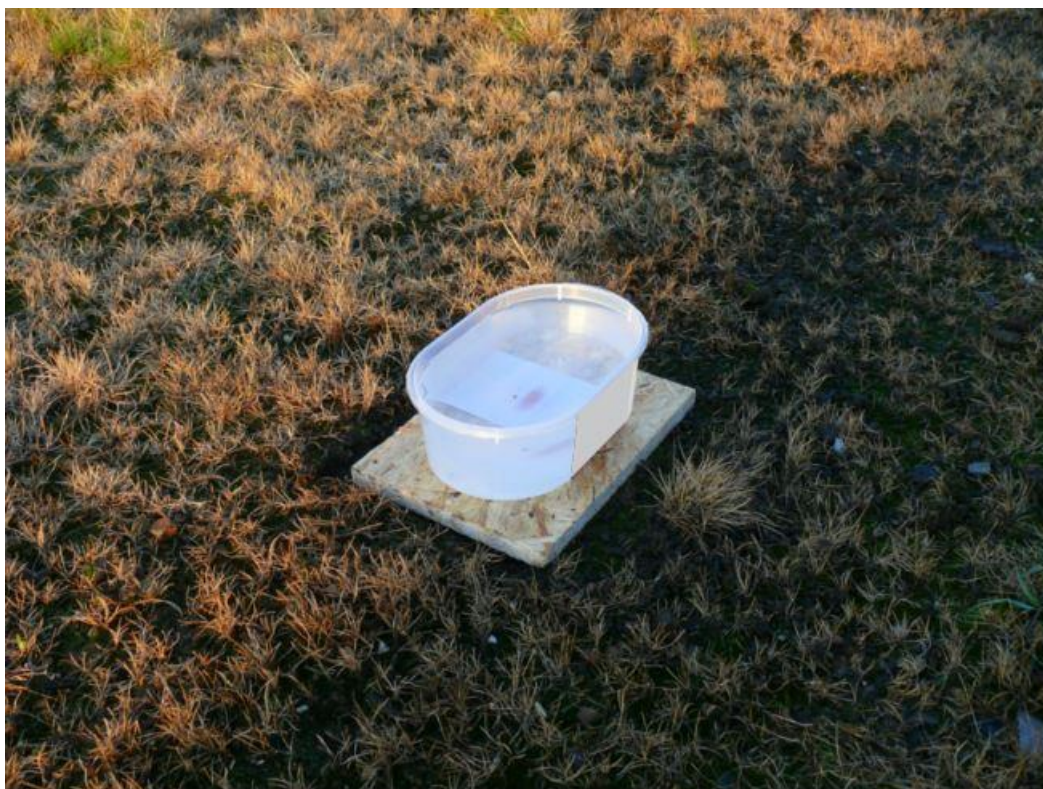
Obr. 6: Čirá plastová nádoba s vyrovnávací podložkou určená pro experiment umístěná na zelené střeše experimentálního centra UCEEB v den evaporačního experimentu.
