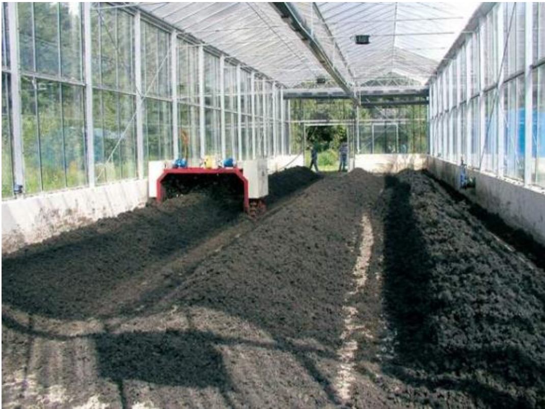
Obrázek 31: Obracení brázd při skleníkovém solárním sušení kalu hubercs.cz
