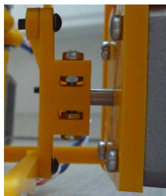
(b) : Uchycení dolního motoru: pohled z boční strany
