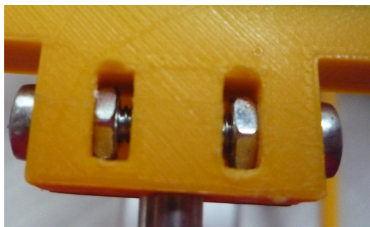
(b) : Uchycení úchopů nebo propojek na hřídel
