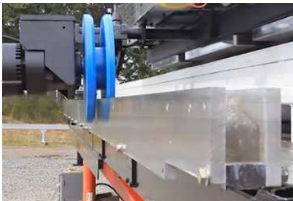
Obr. 79 Princip pohonu transportního levitačního systému Levx [60]
