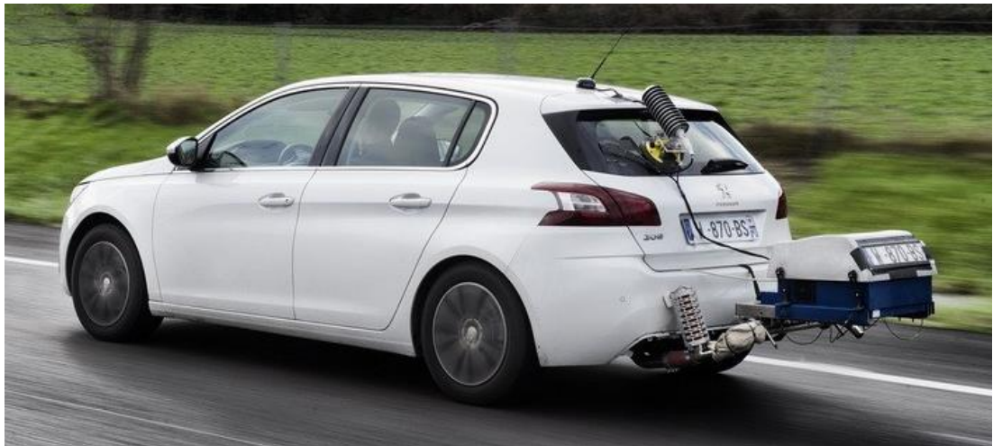
FIGURE 1.4 : MESURE DES EMISSIONS EN CONDUITE REELLE A L'AIDE D'UN PEMS SUR UNE VOITURE PEUGEOT
