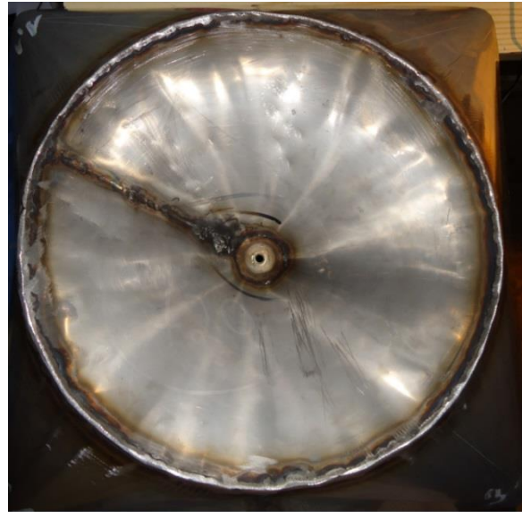
Obrázek 15: Pohled na záchytnou plochu srážkoměru [autor]
