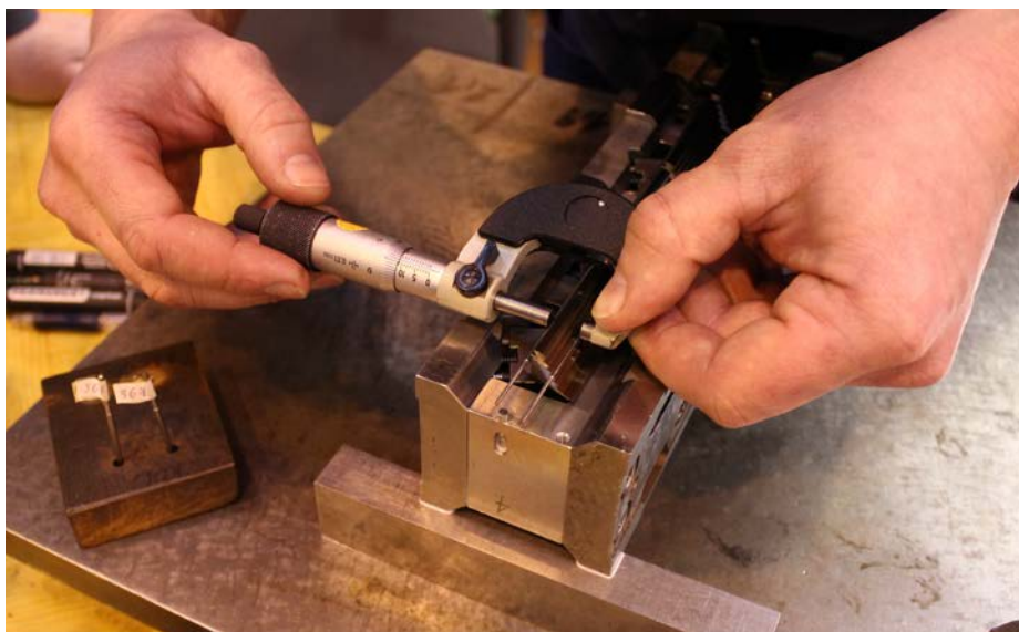
Obr. 26 – Měření rozměrových tolerancí přes válečky
