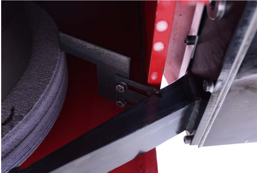
Obr. 27 – Kolize větrné clony s krytem vřetena
