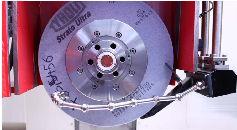
Obr. 24 - Záměna statické trubky za ohebný krk
