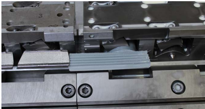
Obr. 22 – Falešná nájezdová lopatka, proti propadu vody
