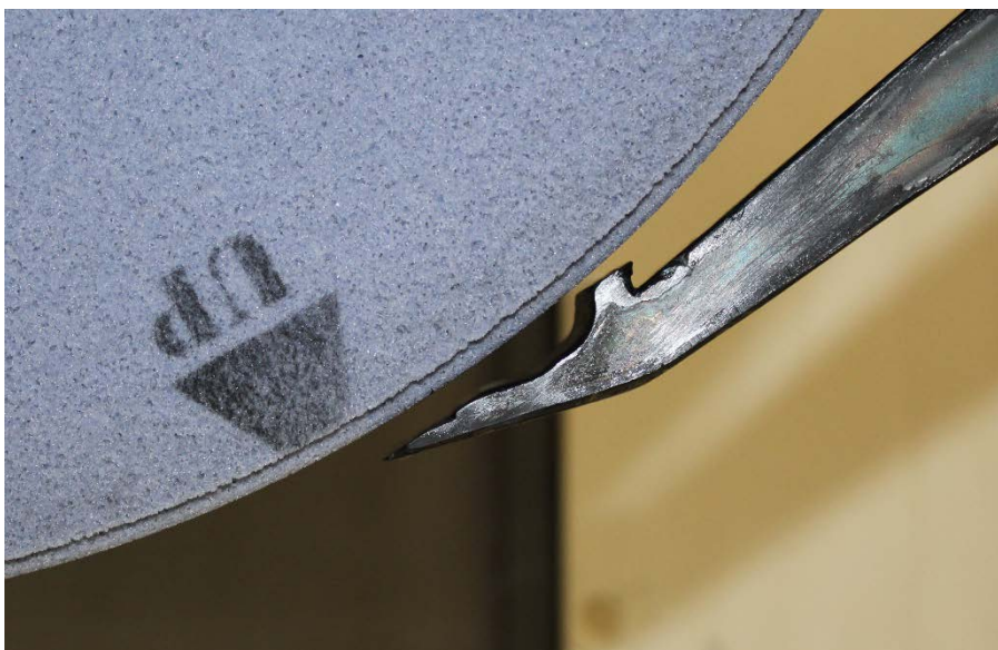
Obr. 20 - Výsledné zpracování trysky ve výchozí pozici vůči kotouči
