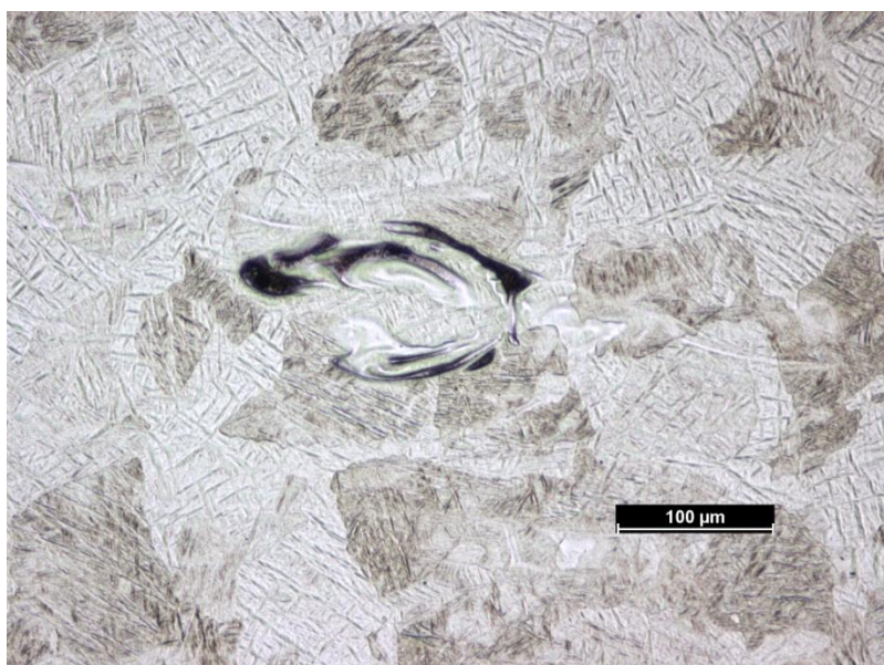
Obrázek p6. Defekt vzorku vyrobeného EBM technologií, optický mikroskop
