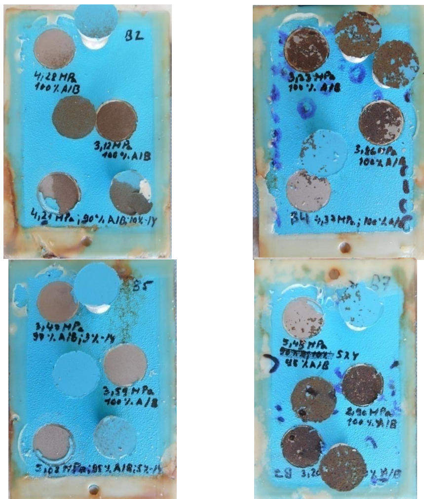
Obrázek 14 - Odtrhová zkouška po expozici B2, B4, B5, B7
