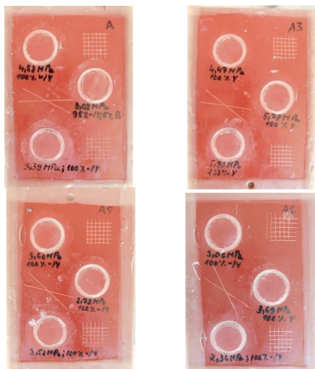
Obrázek 21 - Vzorky A, A3, A5, A6 po provedení zkoušek adheze po expozici
