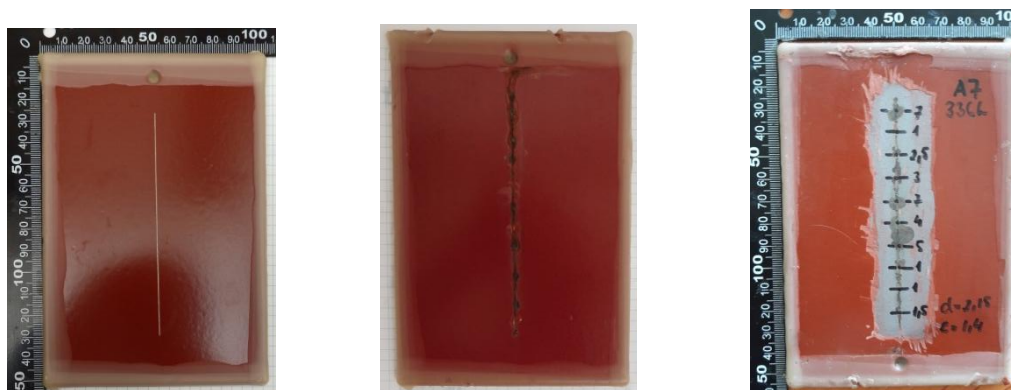
Obrázek 28 - Vzorek A7 - 0 h (vlevo), 336 h (uprostřed), koroze v okolí řezu (vpravo)
