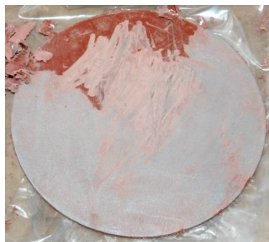
Obrázek 43 - Odstraňování nátěru Intergard 269 (A)
