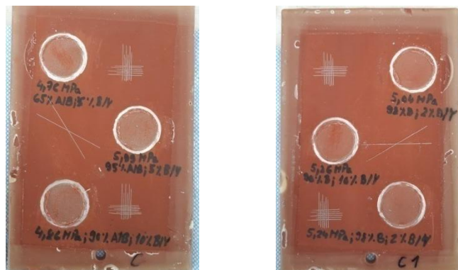
Obrázek 23 - Vzorky C , C1 po provedení zkoušek adheze po expozici
