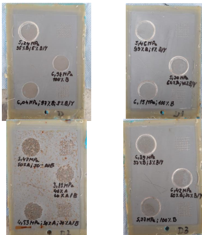
Obrázek 24 - Vzorky D1, D2, D3, D4 po provedení zkoušek adheze po expozici
