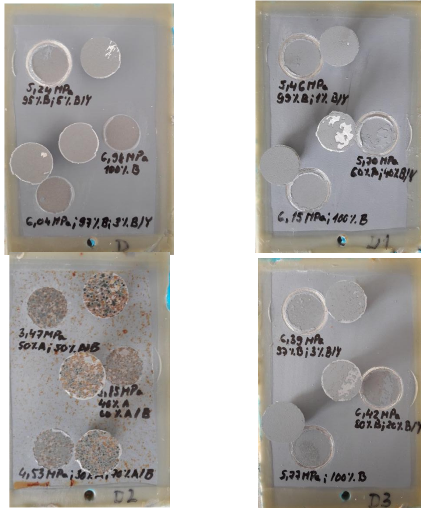
Obrázek 16 - Odtrhová zkouška po expozici D, D1, D2, D3
