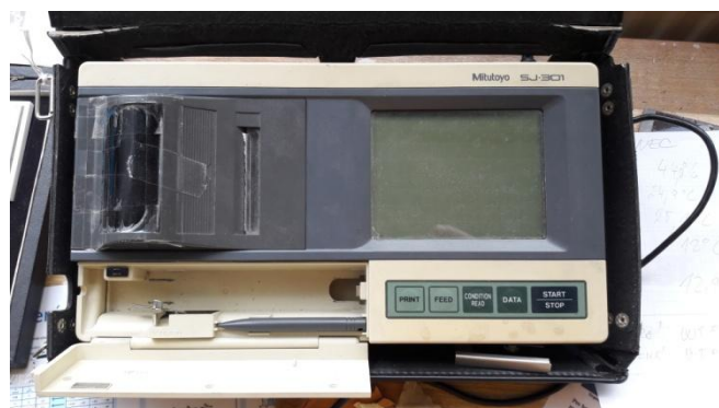
Obrázek 8 - Drsnoměr Mitutoyo SJ-301
