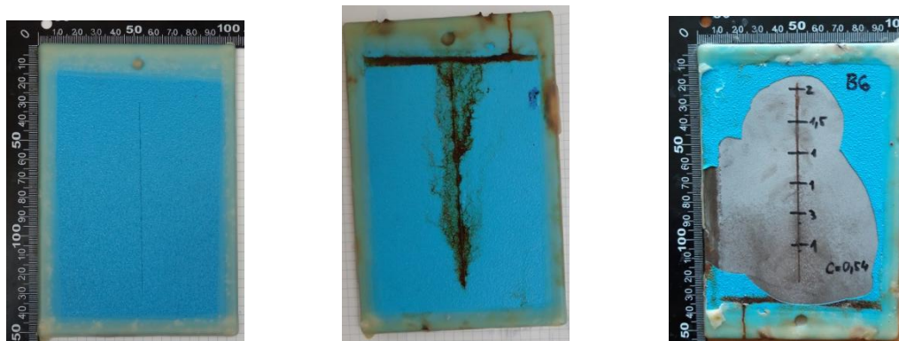
Obrázek 31 - Vzorek B6 - 0 h (vlevo), 336 h (uprostřed), koroze v okolí řezu (vpravo)
