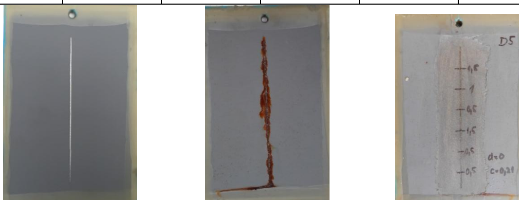
Obrázek 36 - Vzorek D5 - 0 h (vlevo), 336 h (uprostřed), koroze v okolí řezu
