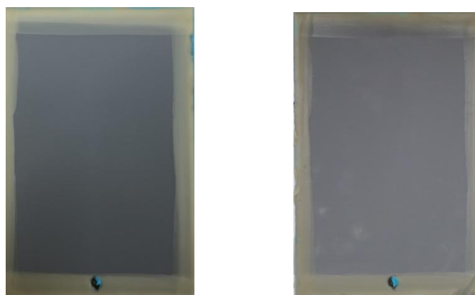
Obrázek 41 - Vzorek D - 0 h (vlevo), 336 h (vpravo)
