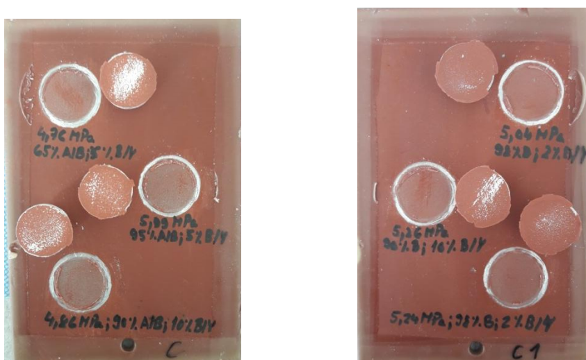
Obrázek 15 - Odtrhová zkouška po expozici C, C1
