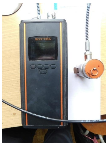
Obrázek 10 - Hydraulický odtrhoměr Elcometer 510
