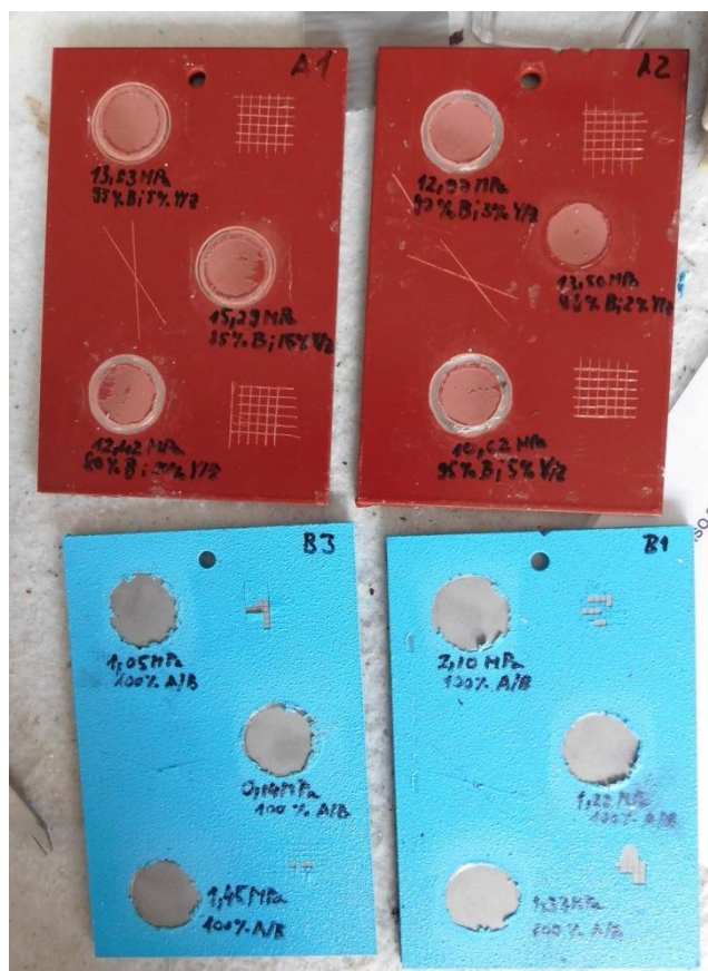
Obrázek 18 - Vzorky A1,A2,B1,B3 po provedení zkoušek adheze
