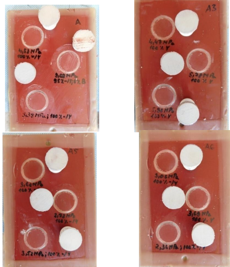
Obrázek 13 – Odtrhová zkouška po expozici A, A3, A5, A6
