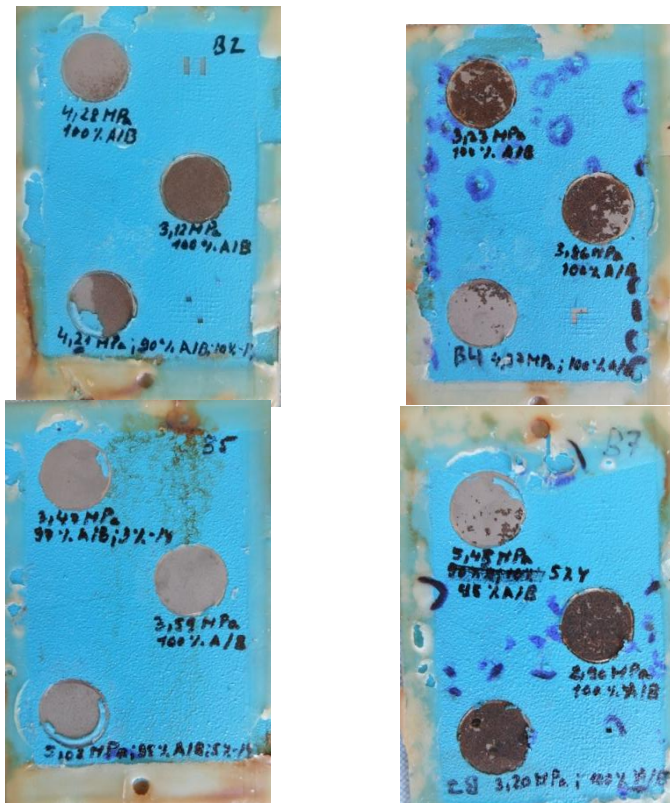
Obrázek 22 - B2, B4, B5, B7 po provedení zkoušek adheze po expozici
