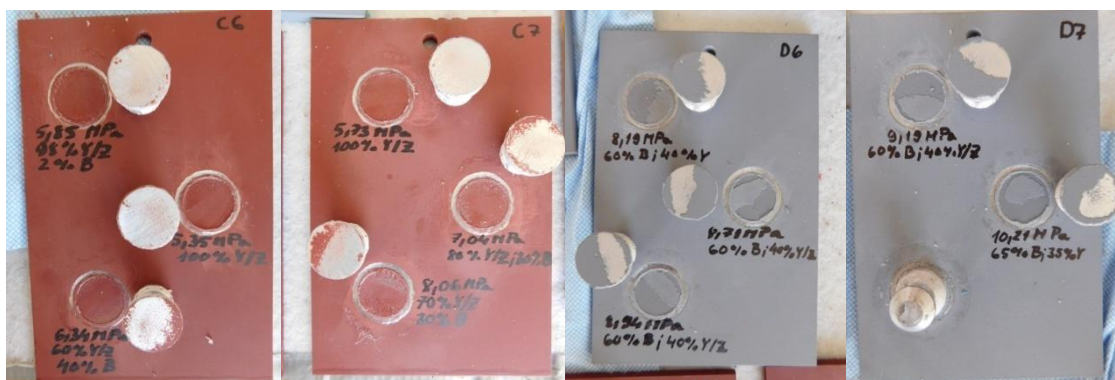
Obrázek 12 - Odtrhová zkouška před expozicí C6,C7,D6,D7
