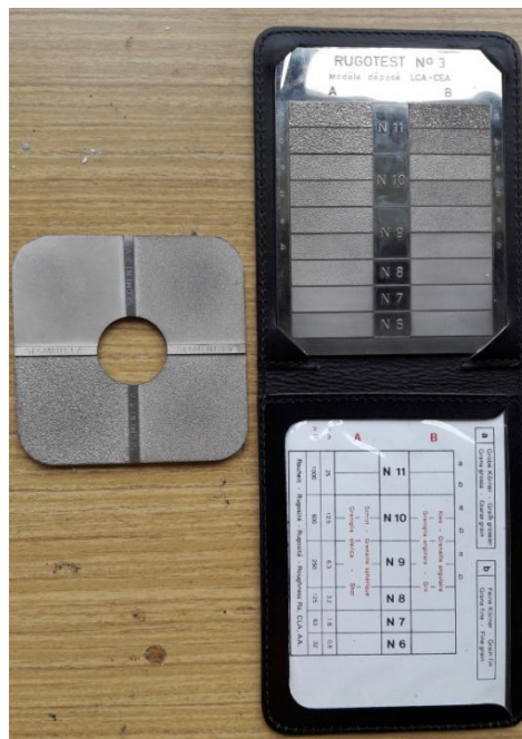
Obrázek 7 - Referenční komparátor (vlevo), Rugotest N° 3 (vpravo)
