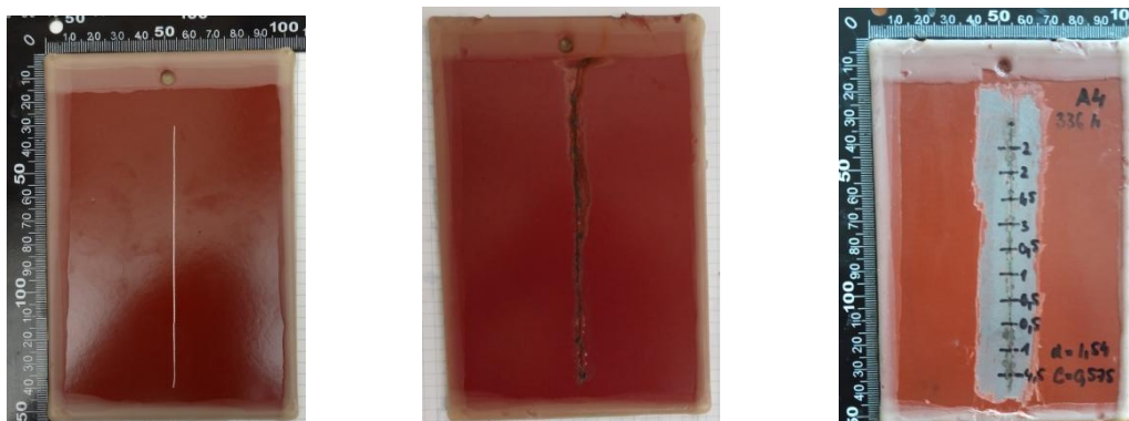
Obrázek 27 - Vzorek A4 - 0 h (vlevo), 336 h (uprostřed), koroze v okolí řezu (vpravo)
