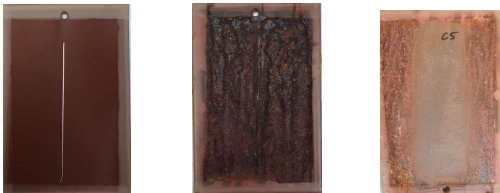
Obrázek 33 - Vzorek C5 - 0 h (vlevo), 336 h (uprostřed), koroze v okolí řezu (vpravo)
