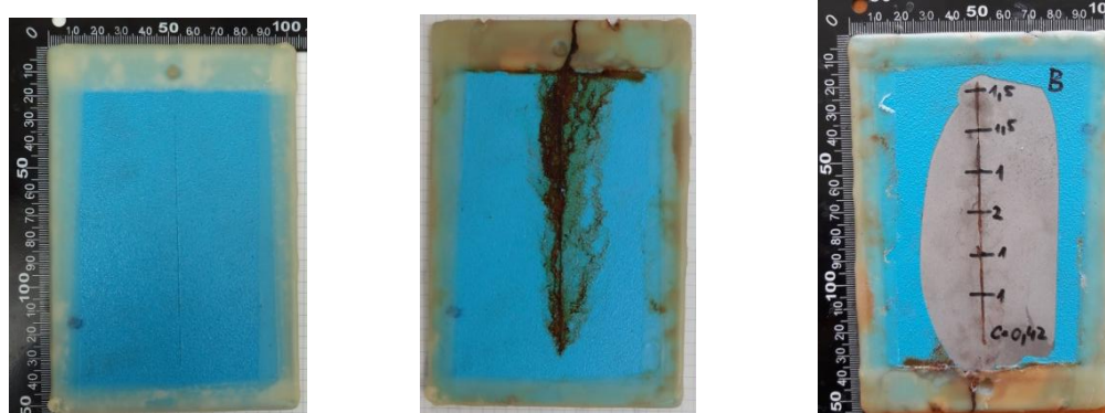
Obrázek 30 - Vzorek B - 0 h (vlevo), 336 h (uprostřed), koroze v okolí řezu (vpravo)
