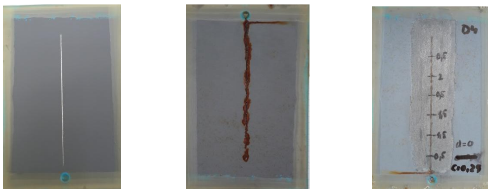
Obrázek 35 - Vzorek D4 - 0 h (vlevo), 336 h (uprostřed), koroze v okolí řezu (vpravo)
