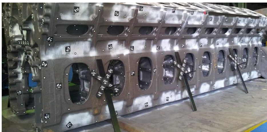
Obr. 13: Rozmístění fotogrammetrických tyčí ve scéně měření
