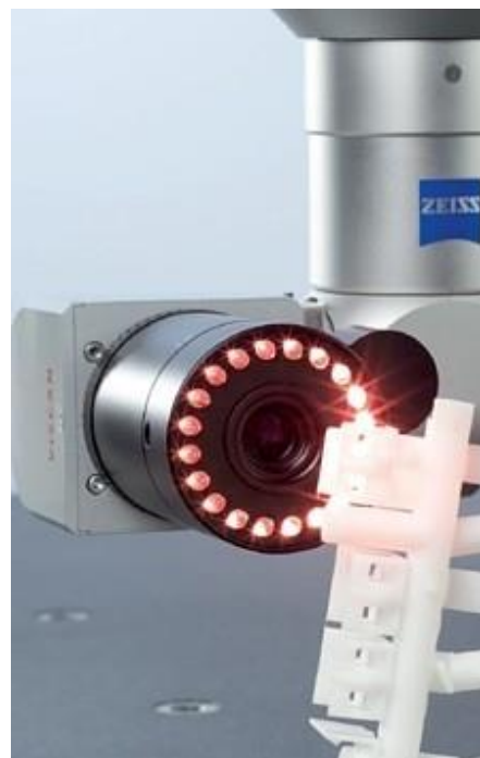
Obr. 15: Optická sonda Zeiss ViScan
