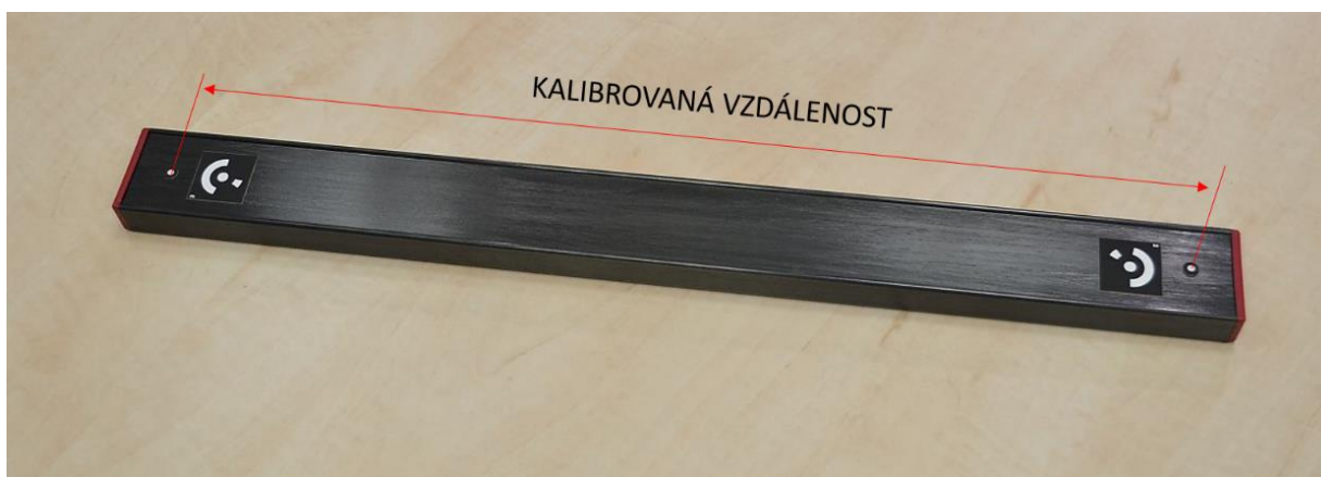
Obr. 11: Fotogrammetrická kalibrační tyč
