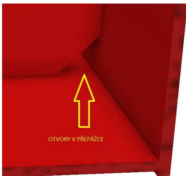
Obr. 6.5. Otvor v přepážce
