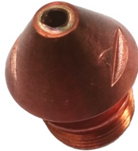
↑ Obr. 14 Opotřebená anoda (tryska) plazmatronu
