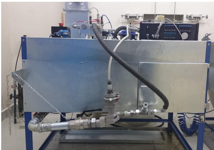
Obr. 14.: Připojené potrubní čerpadlo
