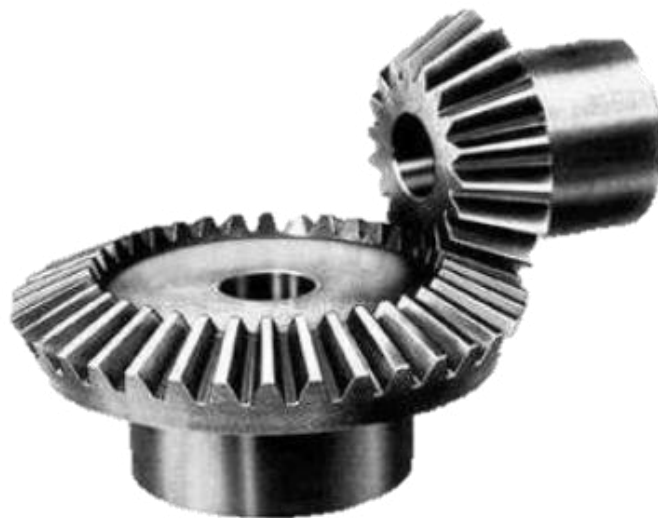
Obr. 8.: Kuželové soukolí s přímými zuby. [12]
