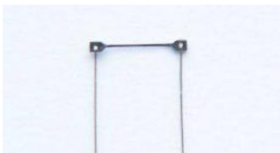
Obr. 34.: Tenzometr bez podložky. [26]
