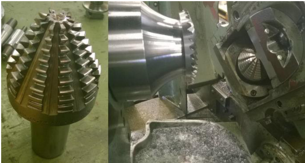
Obr. 25.: Kuželová fréza samostatně a upevněná ve stroji. [15]
